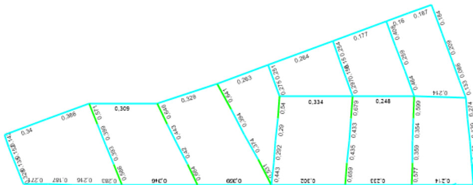
Figura 102. Valores de radio de demanda para vigas del último piso del bloque 4
