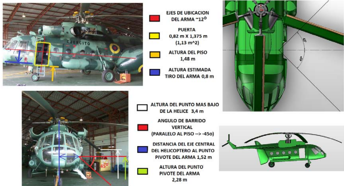
Figura 3.4 Ángulos y medidas base para el desarrollo de soporte, medidas necesarias del MI-171 (Izq. Arriba), ángulos de barrido vista superior (Der. Arriba), distancias críticas y ángulo de barrido vertical (Izq. Abajo), corte longitudinal vista interior del modelo MI-171 (Der. Abajo).
