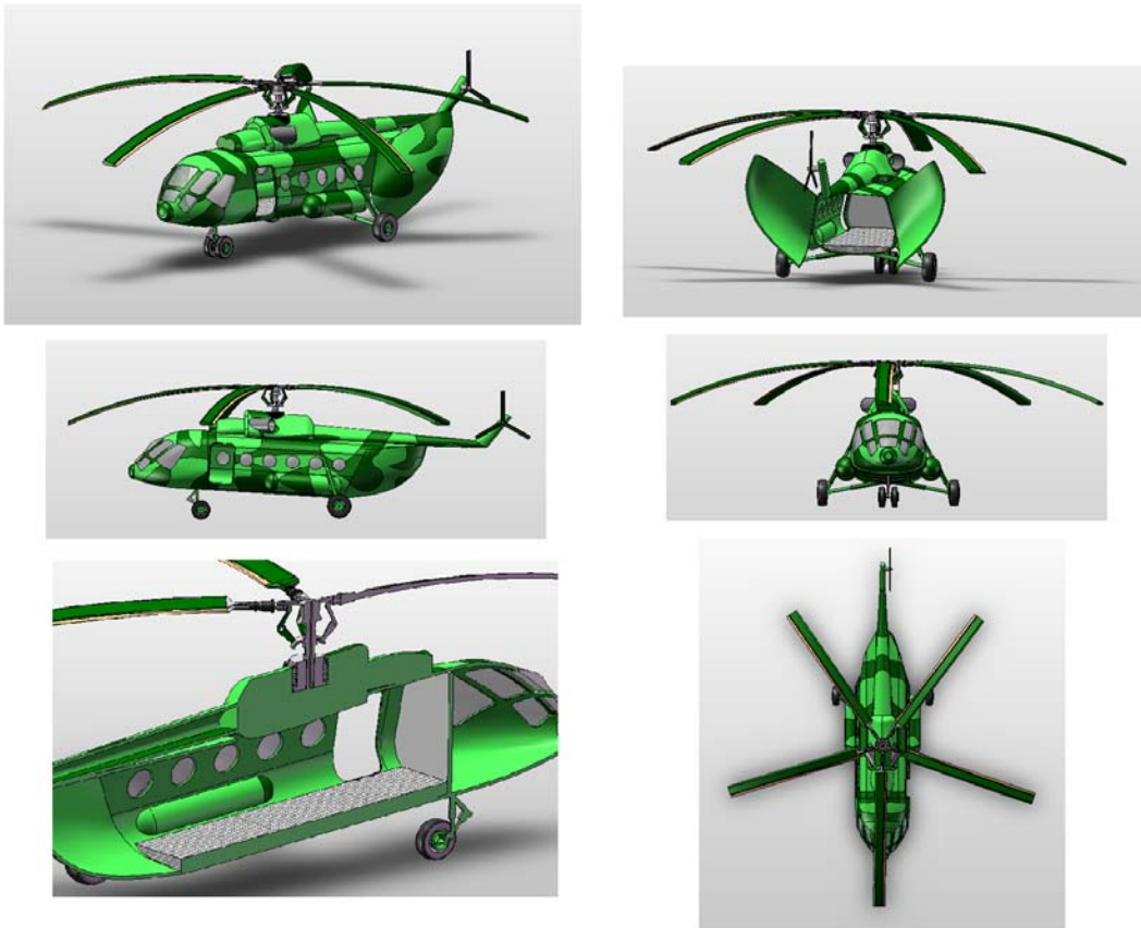
Figura 3.8 Modelo en 3D del MI-171, varias vistas.
