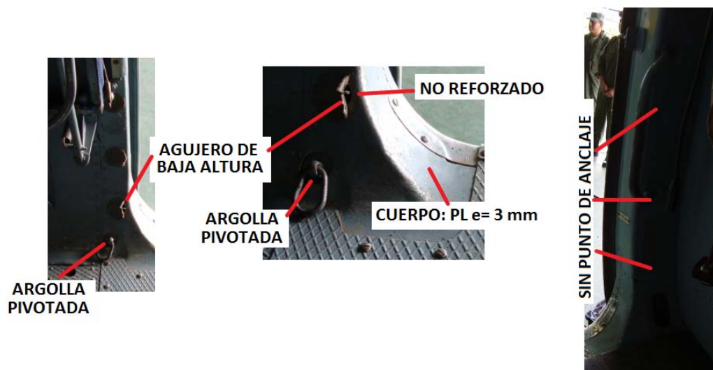
Figura 3.10 Agujeros en el marco del acceso lateral, análisis de elementos y estructura.
