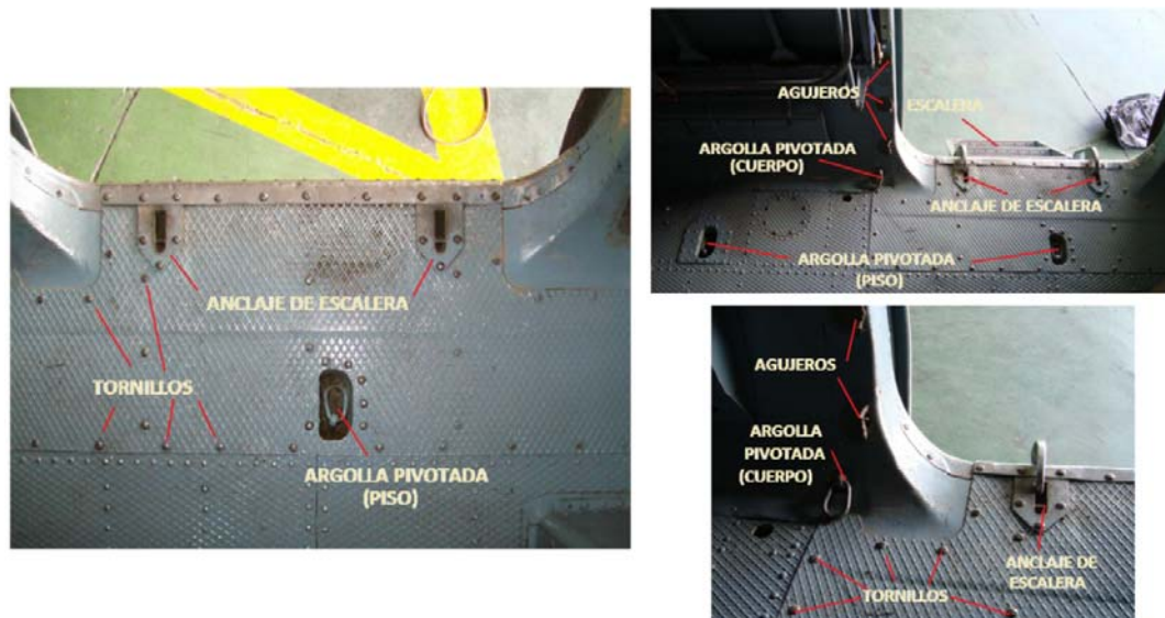
Figura 3.2 Determinación de posibles puntos de anclaje del soporte, puntos principales (izq.) anclaje de escalera y argolla pivotada posterior, todos los puntos disponibles (Der. Arriba) 2 argollas pivotadas de cuerpo y piso mas agujeros reforzados en el filo de la puerta, acercamiento de puntos posibles (Der. Abajo).
