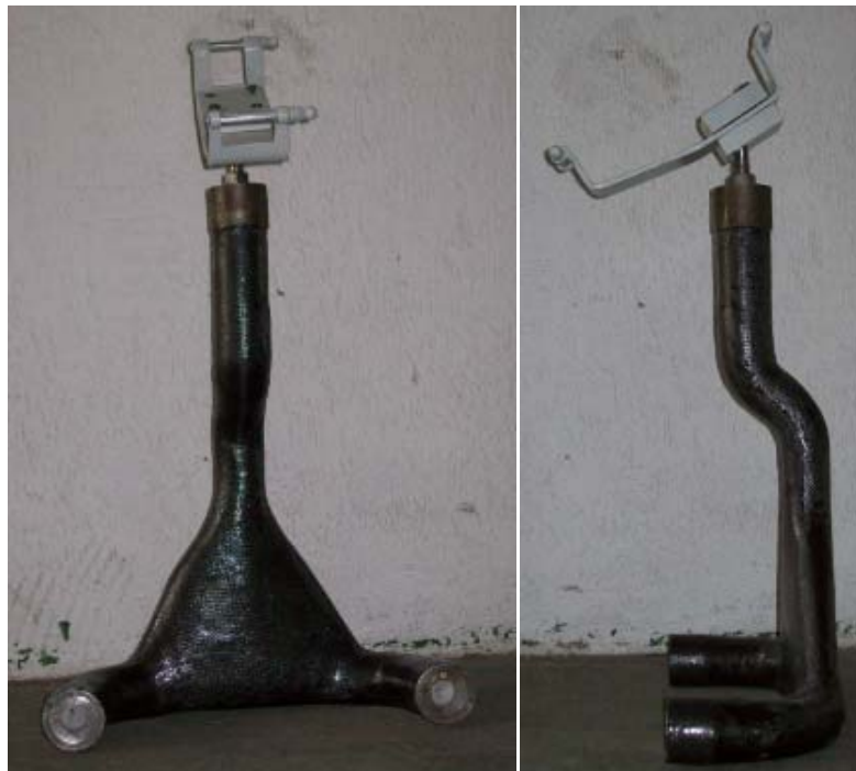
Figura 5.36 Vistas frontal (izq.) y lateral (der.) del soporte terminado
