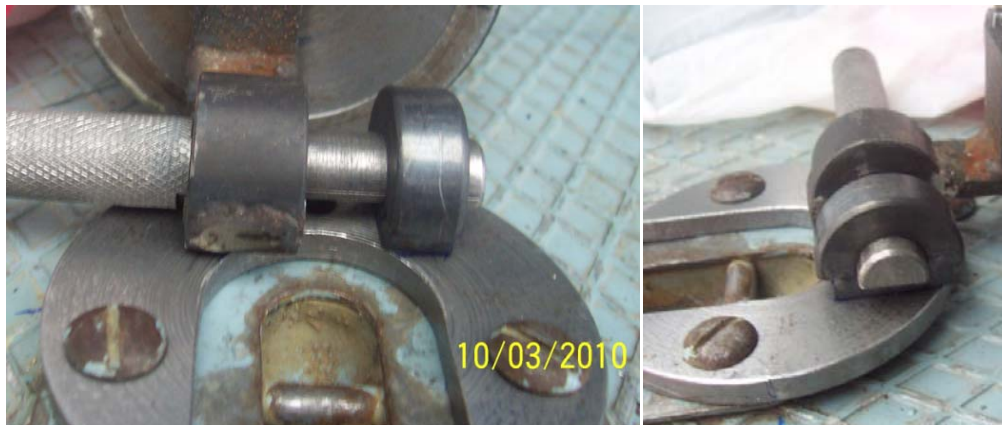
Figura 5.41 Vista de las placas instaladas en el helicóptero y verificación de su ajuste con los acoples metálicos inferiores del soporte
