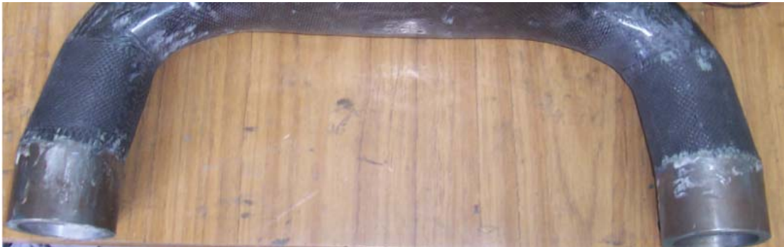
Figura 5.27 Acoples inferiores instalados previos a la laminación exterior
