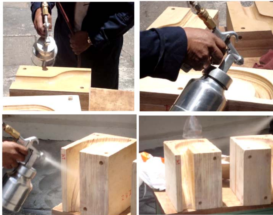
Figura 5.5 Lacado de las caras Internas de los Moldes
