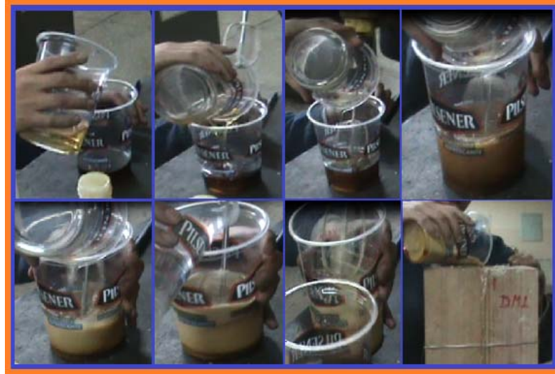
Figura 5.12 Mezclado y Vertido del Poliuretano
