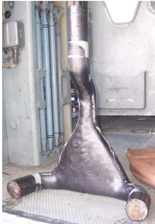
Figura 5.23 Vista del soporte luego de 4 capas de laminado
