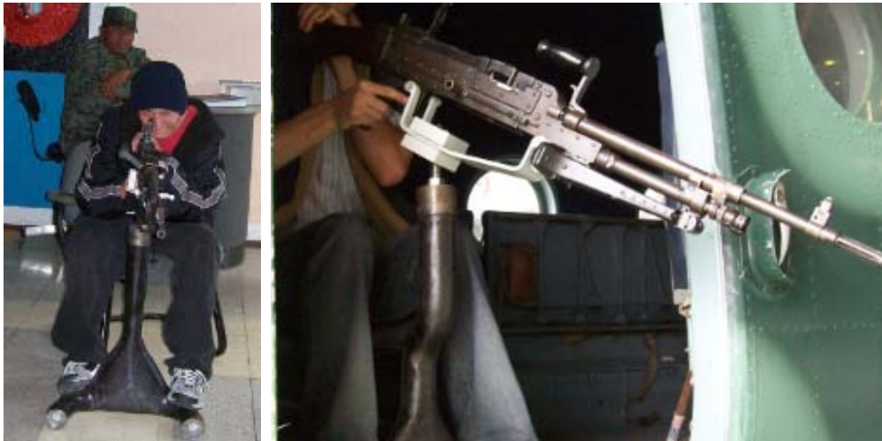
Figura 5.39 Prueba preliminar de de los ángulos de giro del soporte
