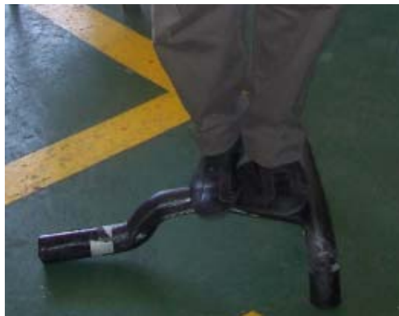
Figura 5.24 Prueba preliminar del soporte luego de 4 capas de laminado
