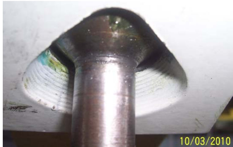
Figura 5.37 Engrasado del área de contacto entre la rótula y el reglaje
