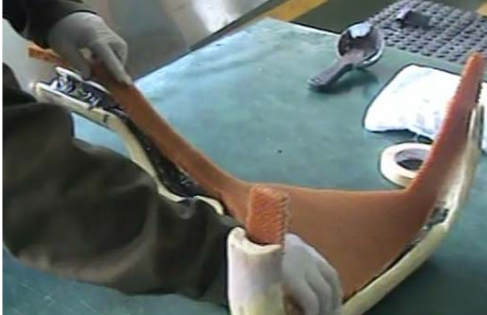
Figura 5.22 Recorte del panal de abejas para instalación en el soporte
