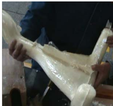
Figura 5.14 Núcleo obtenido por la Fundición de Poliuretano
