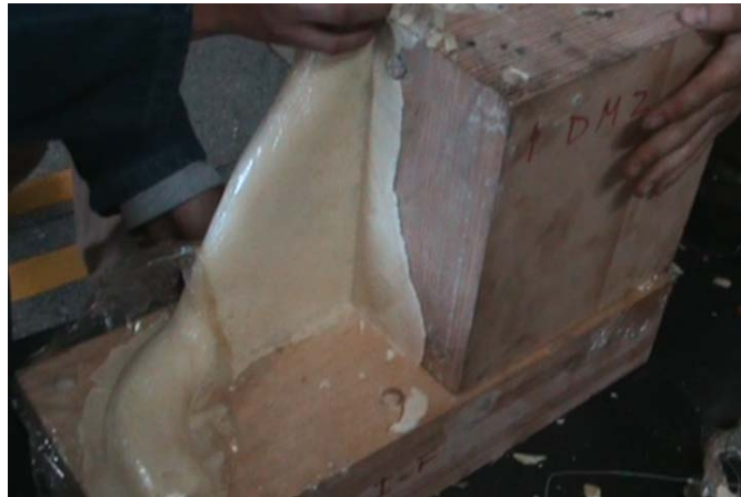
Figura 5.13 Desmolde del Núcleo de Poliuretano
