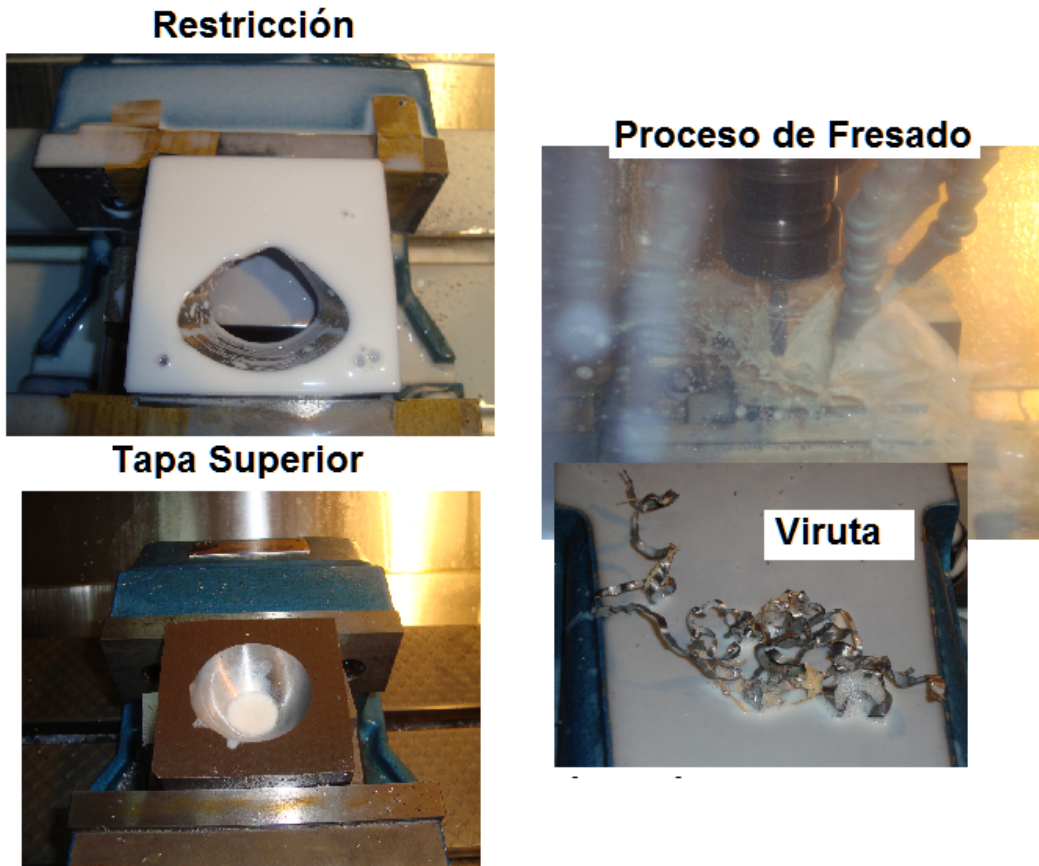
Figura 5.10 Proceso de Maquinado de Acoples
