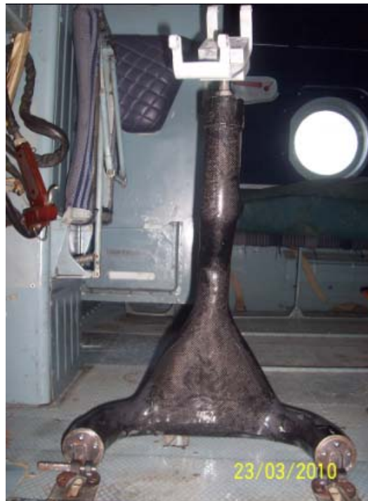
Figura 5.29 Vista del soporte en fibra de carbono terminado
