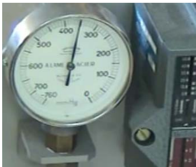
Figura 5.21 Vacío hasta llegar a una presión aprox. de 0.5 atm (380 mmHg)
