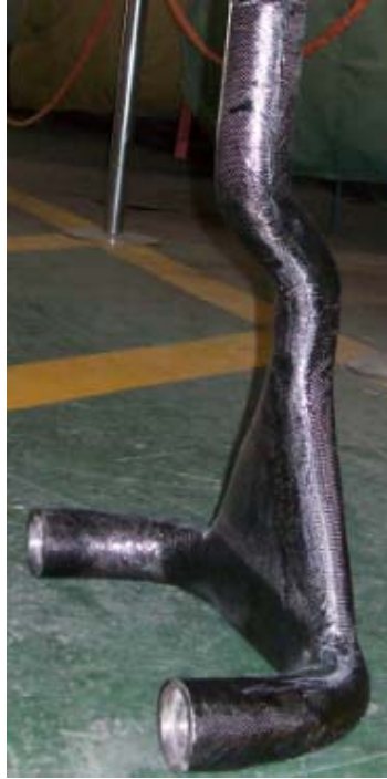
Figura 5.28 Acoples recubiertos con fibra de carbono
