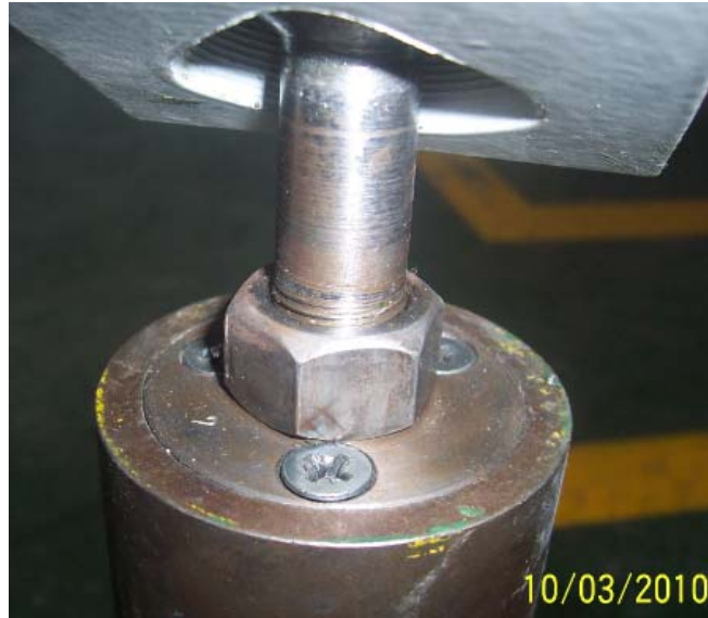
Figura 5.34 Ajuste de la rotula en la tapa metálica del acople superior
