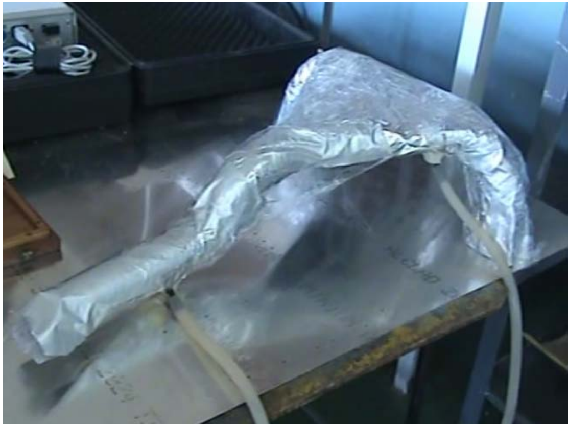
Figura 5.20 Empleo de bomba de vacío para eliminación de burbujas de aire
