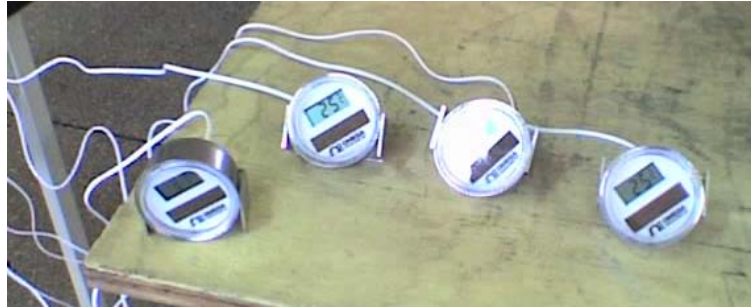
Fotografía 3.2 Medidores de temperatura
