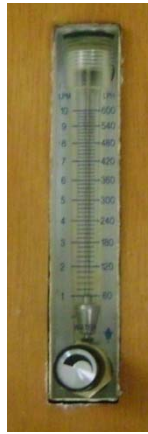
Fotografía 3.1 Medidor de caudal
