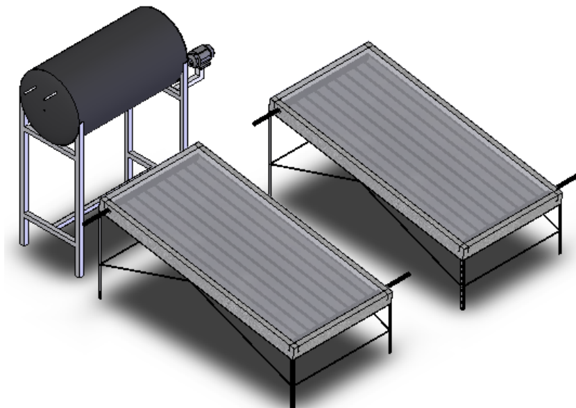
Figura 4.22 Ubicación y Montaje de la Bomba y su Soporte.
