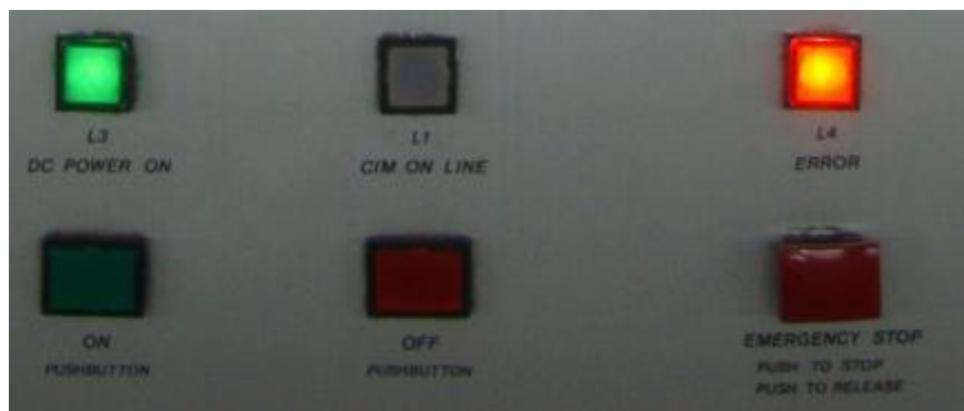
Figura. 8.8. Botón de EMERGENCY STOP presionado HYD-2800.
