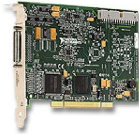
**Figura 2.11 Tarjeta de Adquisición de Datos National Instruments PCI 6221**
