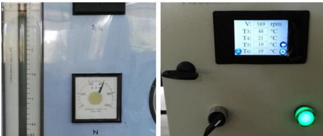
Nota: La imagen de la izquierdo muestra la lectura del tacómetro analógico mientras que la imagen de lado derecho muestra los datos obtenidos por medio de la HMI.
