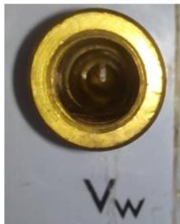
En el desmontaje de la llave se logra constatar la causa de la falla y es la ruptura parcial del sello espiral de material polímero y la falla completa del o-ring de nitrilo, tras la discontinuación de repuestos para la maquina se procede a reemplazar el sello con uno que se encuentre disponible en el mercado.
