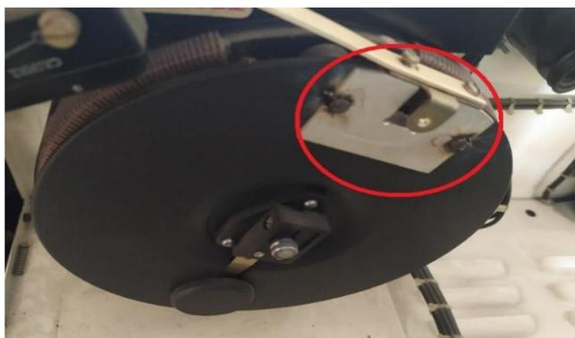
Por lo que se realiza un mantenimiento de los reóstatos, haciendo una limpieza total, corrigiendo los contactos, eliminando impurezas de las escobillas, lubricando los rulimanes de las jaulas y barnizando el material resistivo.
