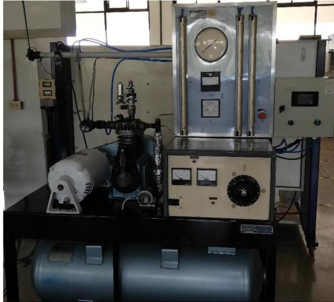
*Nota:* La imagen muestra el equipo completo de la primera etapa de compresión junto al su respectivo gabinete eléctrico, graficador y medidores de humedad y temperatura.
