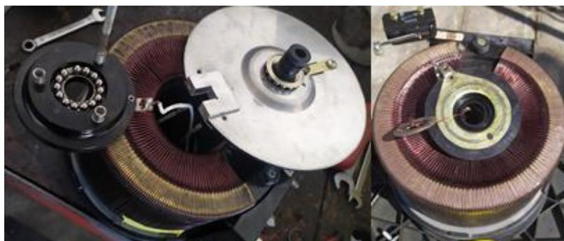
Nota: La imagen de lado izquierdo muestra el lubricado de rulimanes y la imagen de lado derecho muestra cómo se realizó el barnizado de reóstato.
