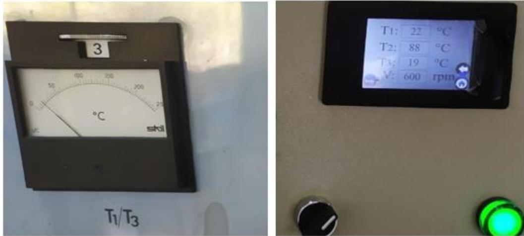
*Nota:* La imagen de lado izquierdo se muestra la lectura del selector de temperaturas (T3) y la imagen de lado derecho se muestra la HMI para la temperatura (T3)
