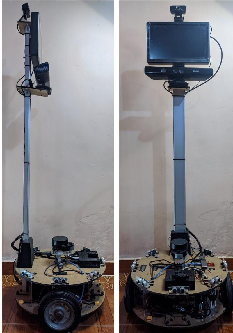
Gracias a las herramientas y librerías brindadas por ROS se implementó un modelo 3D de la plataforma mediante el formato URDF en la cual se representó la descripción física, cinemática, dinámica y el modelo de colisión y visual del robot. El modelo consta de dos partes en general. Los eslabones (links) que describen partes o secciones de cuerpo rígido con parámetros de colisión e inercia, los elementos están vinculados al robot mediante transformadas que indican su posición y orientación. Y las
