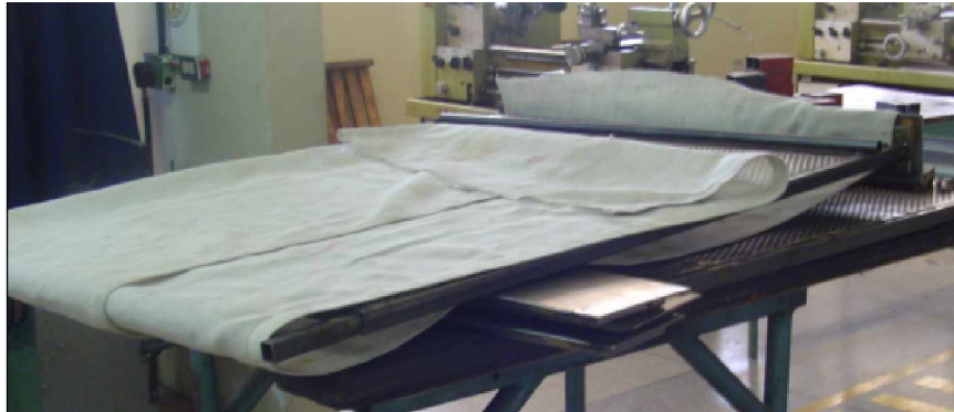
Figura 5.17 Bandeja de alojamiento con malla de amianto.
