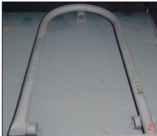
Figura 3.5. Quemador atmosférico tipo flauta
