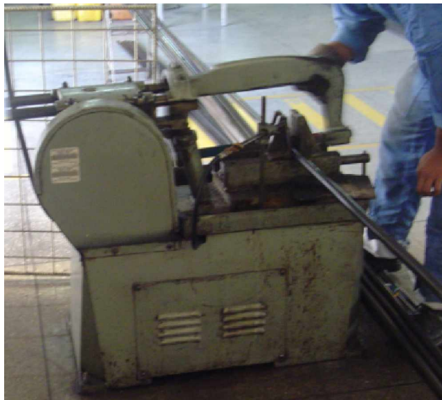
Figura 5.11 Corte de tubos
