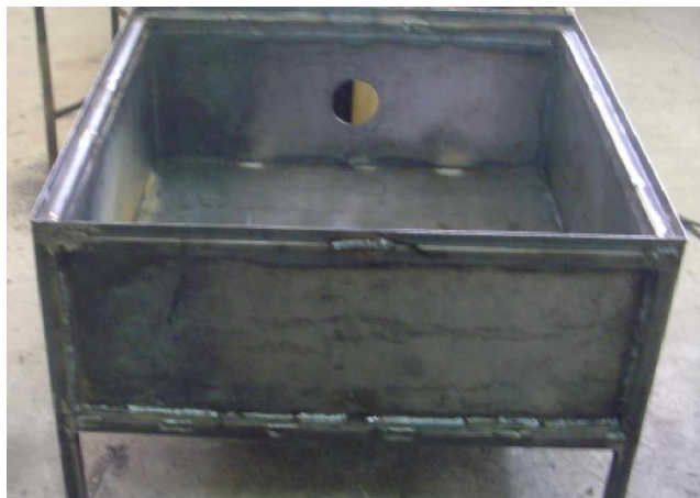
Figura 5.2 Cámara de combustión
