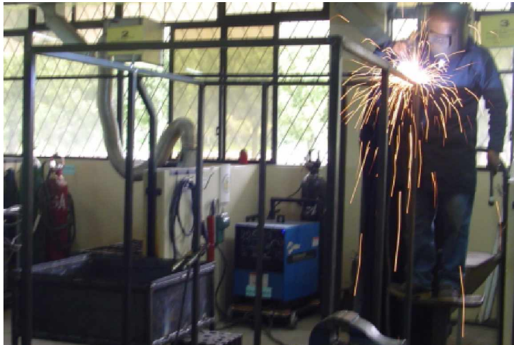
Figura 5.12 Suelda de los tubos 1 ¼" y 1"
