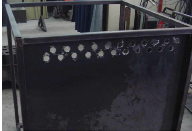
Figura 5.6 Lámina de 3 mm con 22 perforaciones de 1”.
