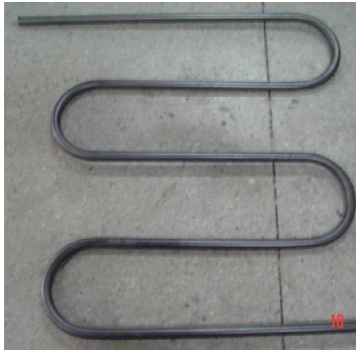
Figura 5.4 Tubo de 1" con 5 pasos para el intercambiador de calor.
