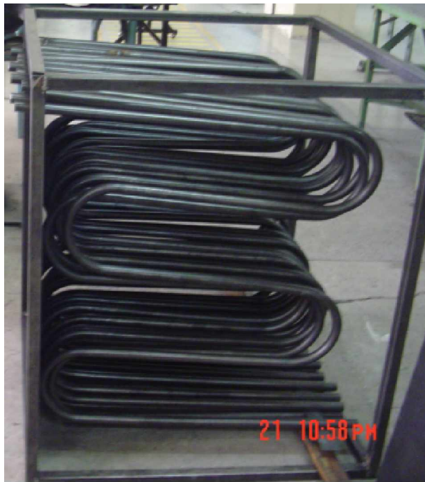
Figura 5.7 Intercambiador de calor.
