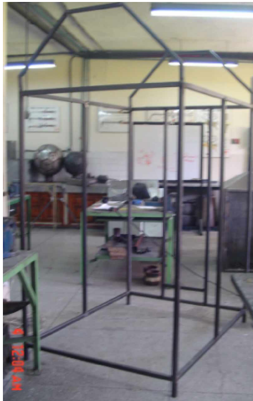
Figura 5.13. Estructura de la cámara de secado.
