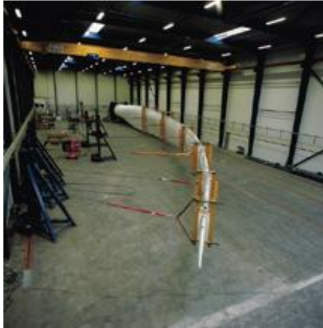
Figura 6.4. Pruebas de Flexión en palas de aerogeneradores
