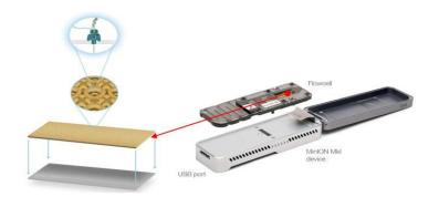
Nota. La gráfica nos indica el dispositivo MinION-ONT y la celda de flujo, donde se observa como la secuencia pasa por el nanoporo, donde por corrientes iónicas se identificará cada nucleótido. Tomado de *Oxford Nanopore MinION Sequencing and Genome Assambly* (p.266). por H. Lu, F. Giordano y Z. Ning, 2017, Genomics Proteomics Bioinformatic.
