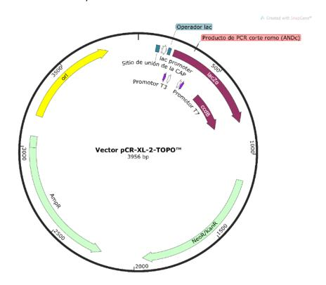
Nota. ori, Origen de replicación; AmpR, Gen de resistencia a Ampicilina (β-lactamasa); NeoR/KanR, Gen de resistencia a Neomicina y Kanamicina (Aminoglucósido 3'-fosfotransferasa); ccdB, Gen de mantenimiento del vector (Toxina CcdB); lacZα. Gen que codifica β-galactosidasa. Realizado por Daniela Sempertegui (2021) con el software SnapGene. Secuencia tomada de ThermoFisher Scientific (https://tools.thermofisher.com/content/sfs/vectors/pcrxl2topo\_seq.txt).
