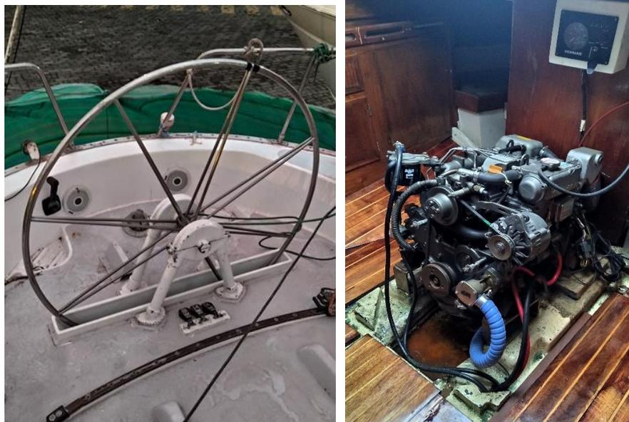
En la imagen del lado izquierdo se presenta el sistema de gobierno del velero oceánico “Alcance”, conformado por el timón, la pala y el servomotor.
