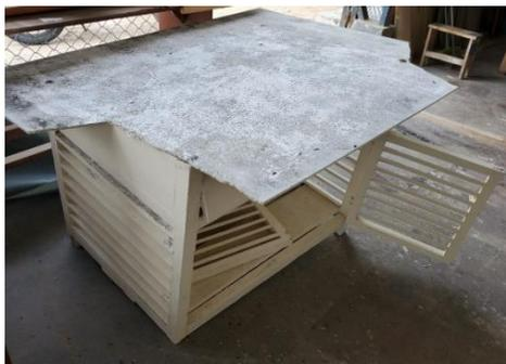
La caseta meteorológica sirve para tener a buen recaudo los termómetros de medición de temperatura como es el termómetro seco, humedo, evaporímetro, el termohidrografo, termómetro de mínima y máxima. No se encuentra en buen estado y se necesita repararla para instalar los equipos.
