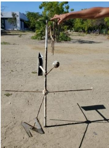
La veleta se asienta en un soporte para darle altura con el fin de que tenga acción del aire en ella. La estructura debe ser alta como sea posible puesto que debe medir la velocidad y dirección del viento en el momento de la observación meteorológica y se lleva un registro histórico.
