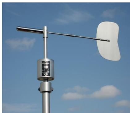
Fuente: W200P/FC Veleta de Viento Potenciómetro (Alpha Omega Electronics, 2020)
