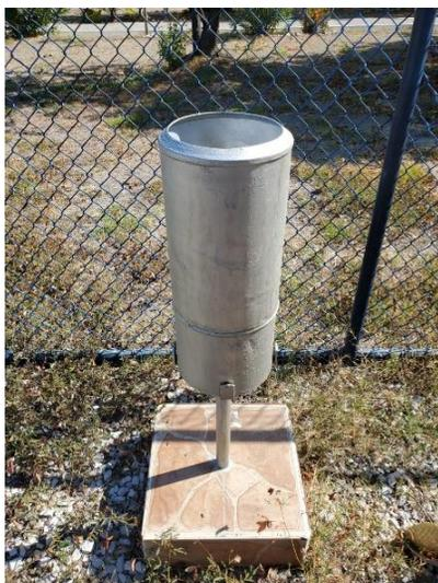
El pluviómetro sirve para captar la cantidad de lluvia precipitada durante un lapso de tiempo, la cual entra en un reservorio y se almacena para que luego el observador revise la cantidad de líquido, vacíe el agua recolectada y procederá a medir con una probeta los milímetros precipitados de lluvia. Para recuperar este equipo se debe verificar que no tenga fugas y darle mantenimiento a su estructura.
