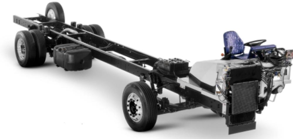
Figura 3.35 Chasis de bus VW 17.210 OD<sup>69</sup>
