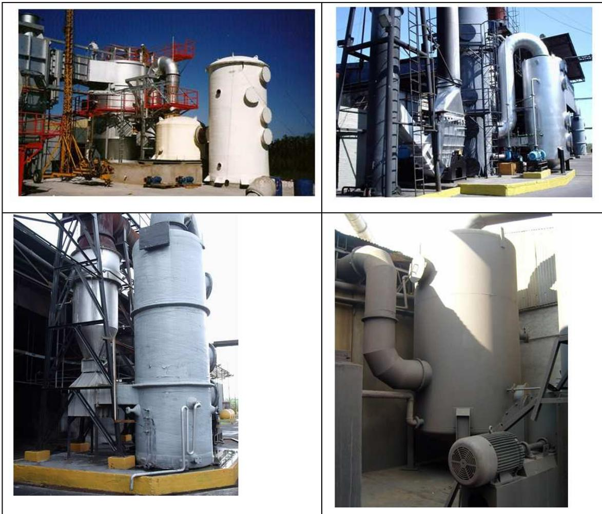
**Figura 7.5** Equipos para de tratamiento de Emisiones Gaseosas
