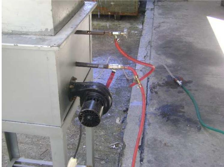
**Figura 6.4** Ensamblaje del venterol y los quemadores
