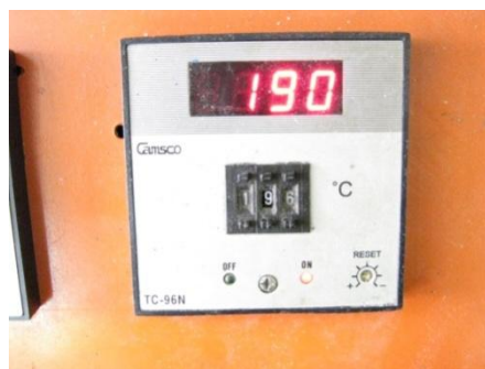
Figura 6.4 Control de Temperatura 190° C
