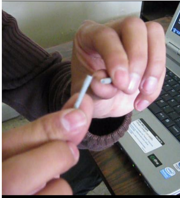
Figura 6.17 Ruptura RPET húmedo
