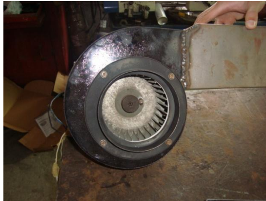
Figura 5.11 Conexión del ventilador con el ducto.
