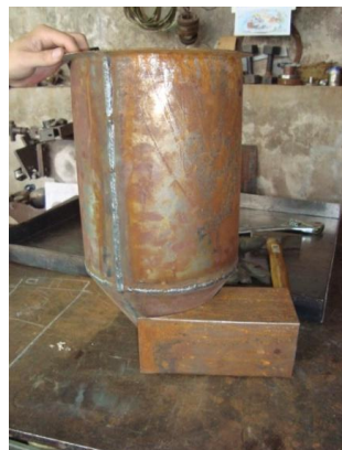
Figura 5.12 Estructura de la tolva y canal.
