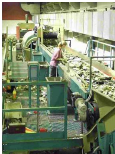
Figura 2.4 Cinta de transportación para clasificación y separación
