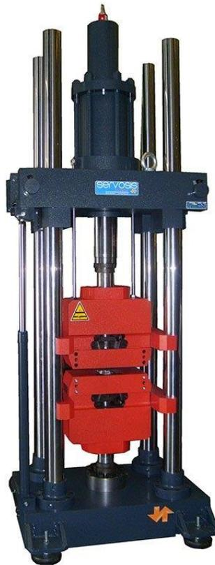
*Nota:* Se utiliza la máquina de prueba universal para el BBT TEST. Imagen extraída de (SERVOSIS, 2021).
