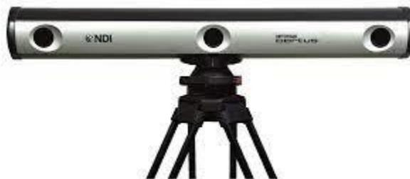
*Nota:* Se utiliza la cámara Optotrak para captura de movimiento. Imagen extraída de (Inc, 2015).
