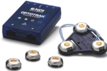
*Nota:* Se utilizan los sensores (markers) para que la cámara optotrak tenga puntos de referencia de movimiento. Imagen tomada de (Koster, 2016).
