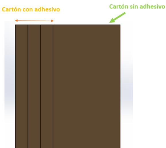
En la Figura 35, se ve claramente como el papel debe entrar el papel de forma escalonada, es importante aclarar, que cada una de las capas de poseer la cara superior engomada a excepción de la primera capa que tiene contacto directo con el núcleo, debido a que esta se desliza a lo largo del eje, y este debe ser liso sin ningún tipo de residuo.
