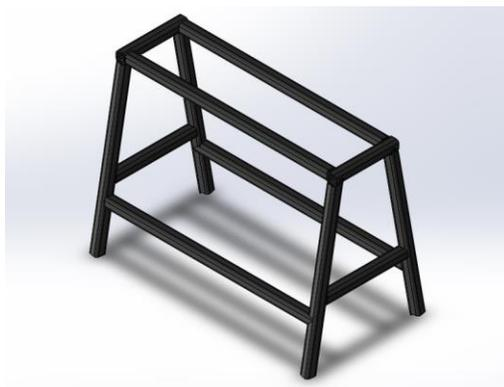
La estructura base Figura 33 contara con una placa de 6mm de espesor suficiente para poder, anclar la estructura donde se anclará el eje de núcleo de los tubos de cartón, este eje podrá medir de 2 a 6 pulgadas de diámetro; y además de esto la palca contara con 3 ranuras que permitirán, la rotación del ángulo de la banda y permitirán desplazar el sistema motriz de la máquina hacia atrás o adelante, pensando en que posteriormente se aumentaran el número de capas a la máquina.
