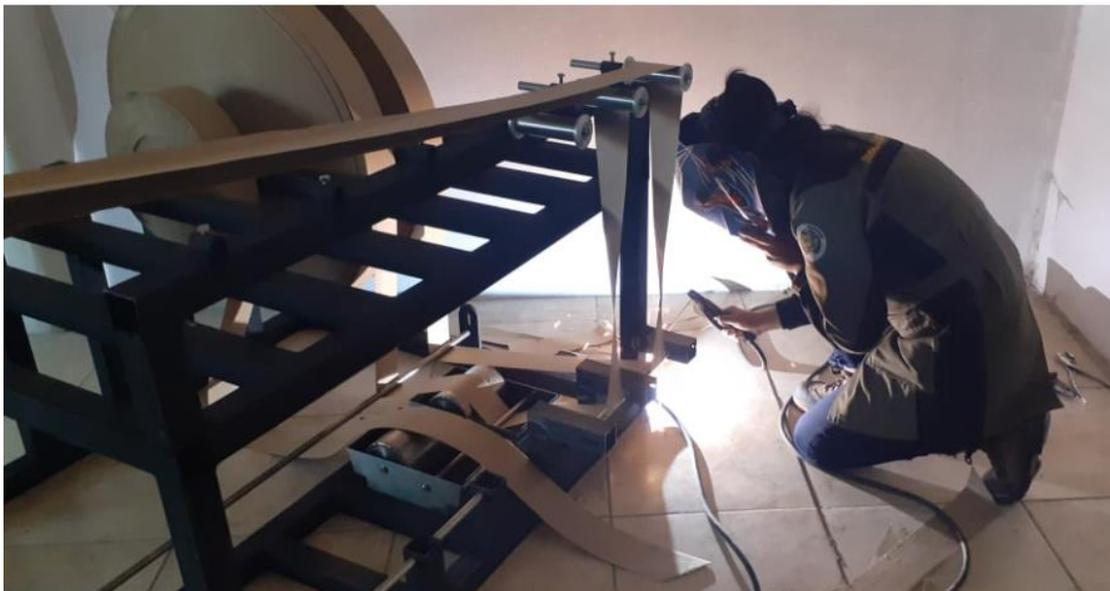
**Figura 115***Estructura de la entubadora*
