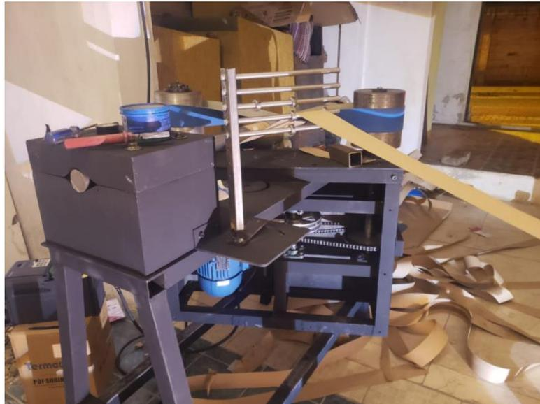
Se debe tener en cuenta que la máquina construida está diseñada para una expansión a futuro, es decir, la colocación de más capas para productos diferentes de esta manera poder diversificar el mercado, además de esto, la cortadora está diseñada para ubicar más cuchillas de esta manera poder reducir aún más los tiempos de producción.
