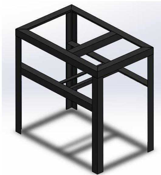
Al igual, que los módulos anteriores constan de una mesa pequeña, Figura 37, en la cual reposara el sistema móvil de cortado. Esta mesa será utilizada como soporte para el brazo cortador y el sistema motriz que reposara en la parte inferior.
