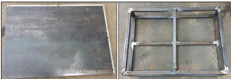
Posteriormente se remacha la placa en la estructura, se aplica una capa de fondo automotriz y pintura (Ver Figura 132).
