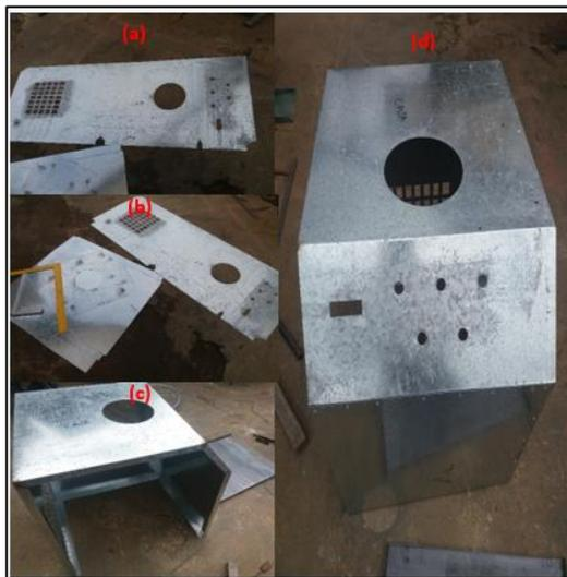
*Nota.* Las figuras (a) y (b) muestra el corte en la plancha de acero galvanizado, (c) el doblado de la estructura y (d) su aspecto aun sin aplicar pintura.
