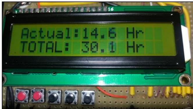
Con ayuda de los pulsadores puede configurar el intervalo de horas para la acción de mantenimiento preventivo (por defecto este valor fue fijado en 480 horas), confirmar la acción de mantenimiento para apagar la señal de aviso como se puede observar en la Figura 130.
