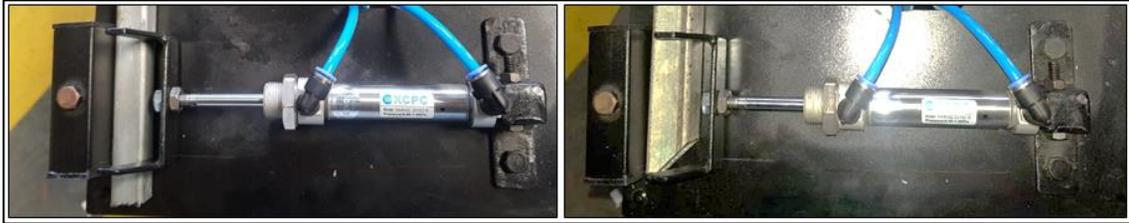
*Nota.* Se observa la sujeción de perfiles cuadrados máximo de 1 pulgada.
