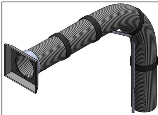
El análisis estático se desarrollará de manera independiente para cada componente. En el caso del brazo principal se considera la acción de la gravedad y el peso del resto de elementos como una carga puntual a determinada distancia, para ello con ayuda de las herramientas de medición del software Solidworks se determina una masa de 2035,05 gramos a una distancia  $Y = 87,14 \text{ mm}$ ,  $Z = 677,83 \text{ mm}$  medida desde el punto de conexión (Figura 63).
