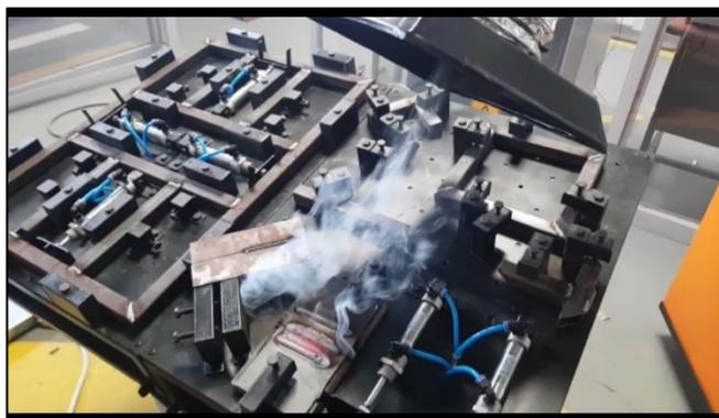
*Nota.* En la imagen se puede observar como la campana de aspiración extrae el humo generado en el proceso de soldadura.
