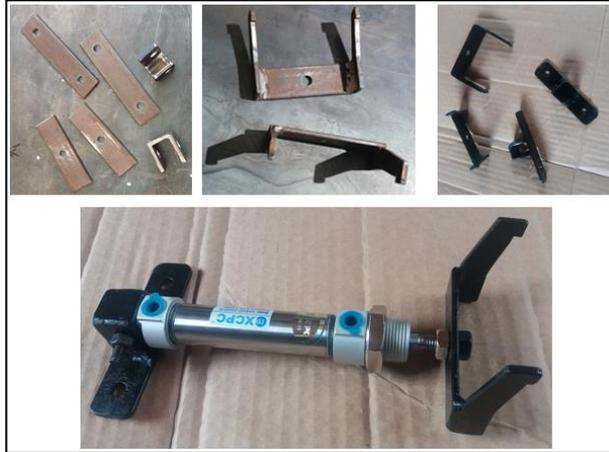
Finalmente, todos los elementos se fijan en el jig con ayuda de pernos y tuercas de 8 mm (5/16 de pulgada) como se observa en la Figura 135.
