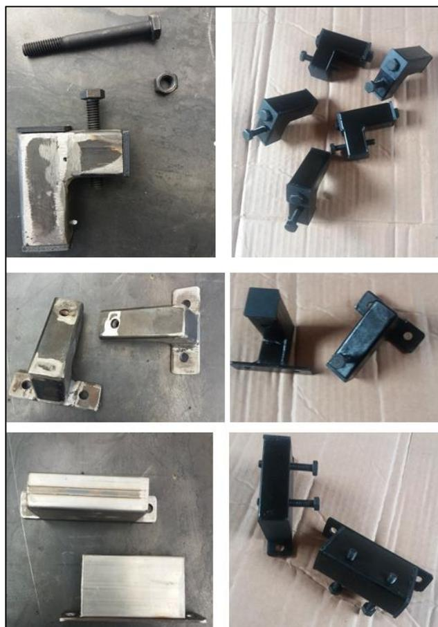
Del mismo modo se procede con los clamps neumáticos a ser utilizados para sujetar los perfiles estructurales, en la Figura 134 puede observar los elementos y ensamble del clamp.
