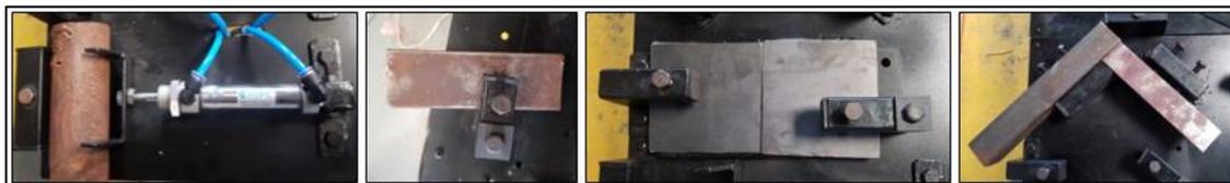
*Nota.* Se observa una sujeción de perfiles circulares, rectangulares, placas y ángulos de los diferentes clamps.
