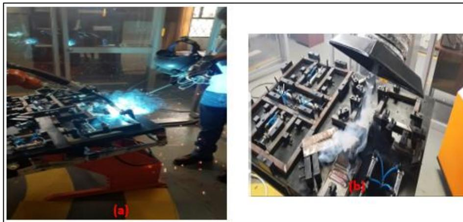
*Nota.* La figura muestra en (a) prueba de soldadura y contaminación de los humos emitido en el proceso y en (b) el sistema actuando sobre la emanación producida.
