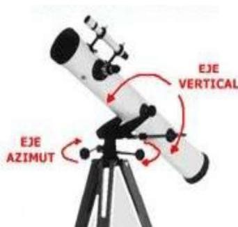
*Nota:* La figura muestra la disposición de ejes en la montura azimutal. Tomado de SEDA/LIADA, Montura Altacimuntal por J. Sanabria, 2020.
