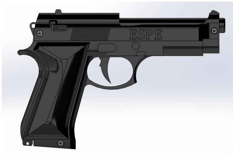
El prototipo está compuesto de diferentes partes, para su facilidad de ensamble y manufactura la estructura principal se la dividió en dos partes, en la Figura 43 se muestra la vista lateral izquierda.
