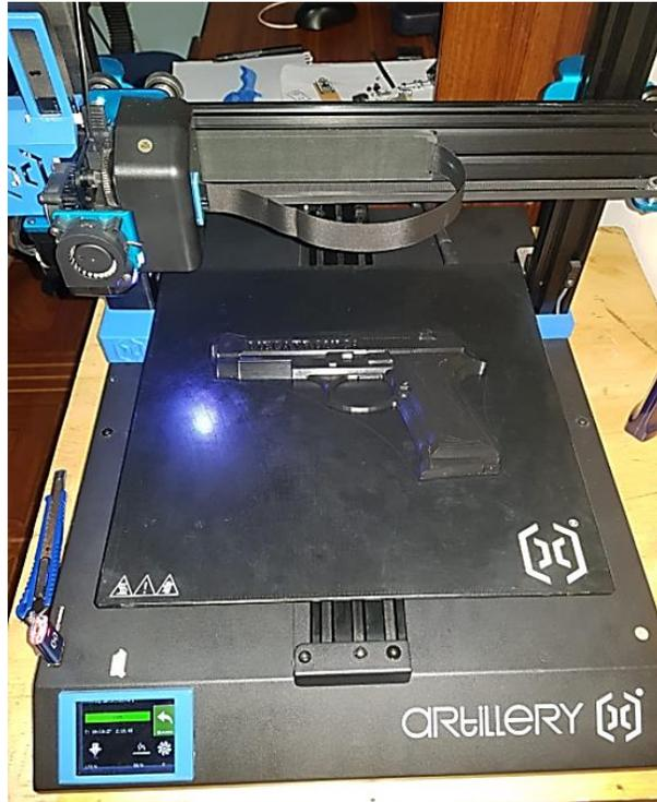
En la figura 66 se observa como una parte izquierda del mando ha sido impresa, usando la misma configuración del programa Cura, se procedió a la impresión de las demás piezas para su posterior ensamble.
