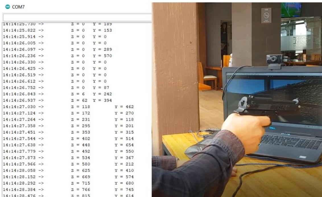
En la figura 100 se puede observar que al empezar el movimiento del prototipo de arma diseñado los valores empiezan a variar, esto recae en que son llevados al entorno de realidad virtual de forma satisfactoria.
