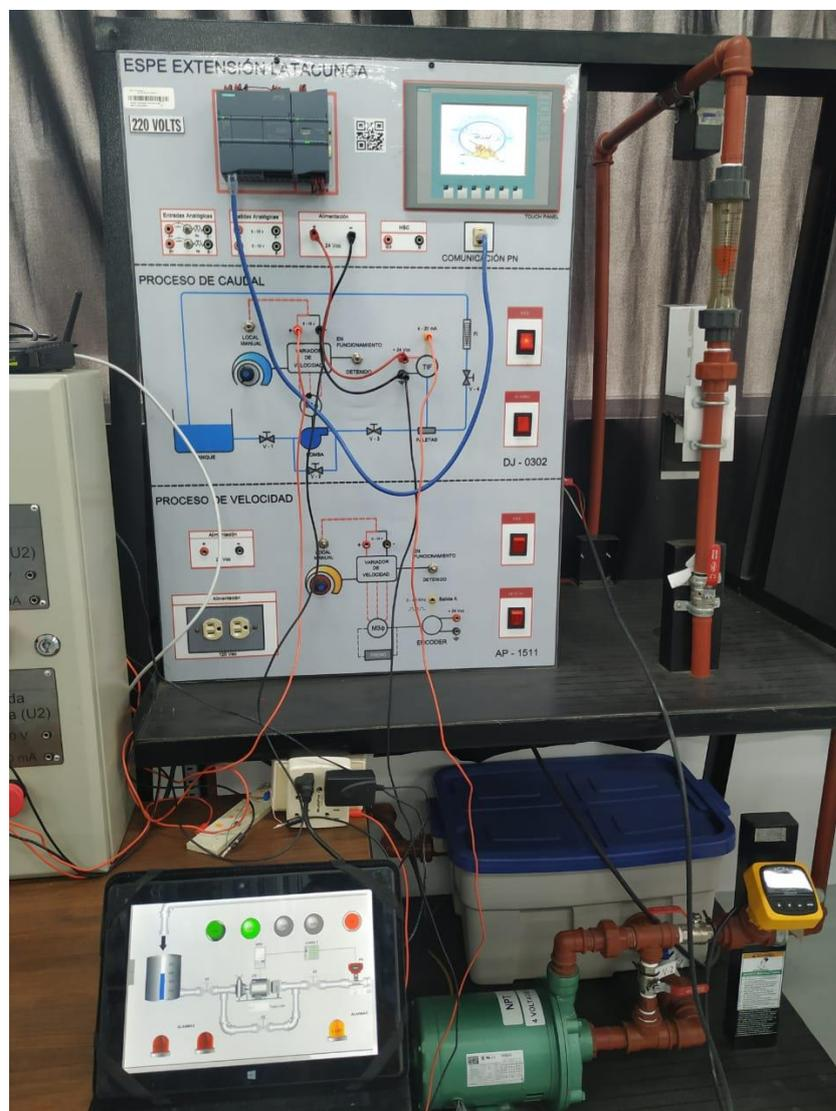
*Nota.* Estación de caudal AP-1511 y panel de supervisión remoto en funcionamiento.
