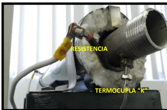
*Nota:* En el gráfico se puede observar la conexión de la termocupla tipo "K" a la salida del tubo reactor y la resistencia eléctrica con su respectivo cable para su conexión
