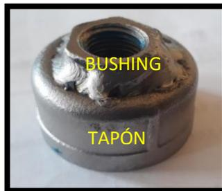
*Nota:* En el gráfico se puede observar el bushing NPT soldado al tapón, con la soldadura por arco eléctrico.
