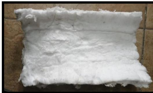
*Nota:* En el gráfico se puede observar la fibra cerámica utilizada como aislamiento térmico para mantener las temperaturas de trabajo de 300 °C a 350 °C.
