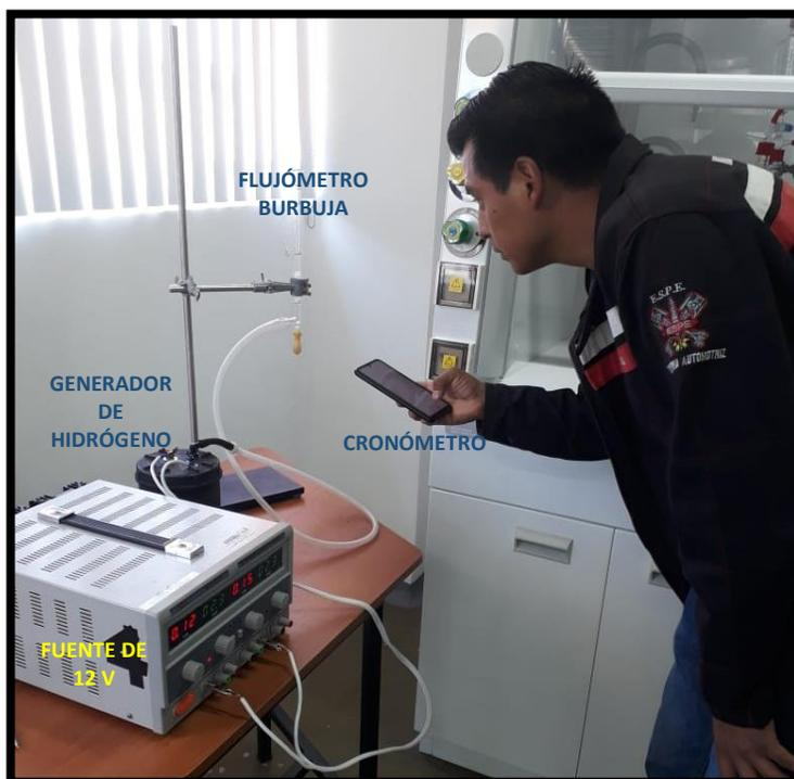
*Nota:* En el gráfico se puede observar la calibración del generador de hidrógeno con la ayuda del flujómetro de burbuja y un cronómetro.
