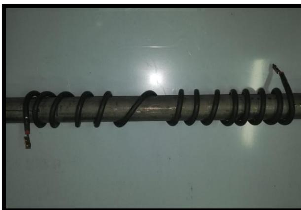
*Nota:* En el gráfico se puede observar la resistencia eléctrica en espiral, enrollada al tubo reactor la cual alcanza una temperatura de 500 °C.
