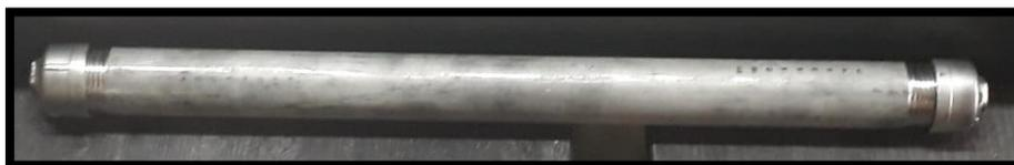
*Nota:* En el gráfico se observa el ensamble final de tubo reactor ideal para el tratamiento
