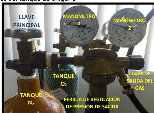
*Nota:* En el gráfico se puede observar los tanques de oxígeno, nitrógeno con sus respectivos manómetros y llaves que sirven para regular la presión de salida del gas.
