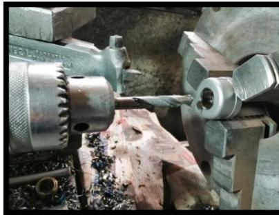
*Nota:* En el gráfico se puede observar la perforación del tapón con un taladro eléctrico y una broca de 15 mm de diámetro.
