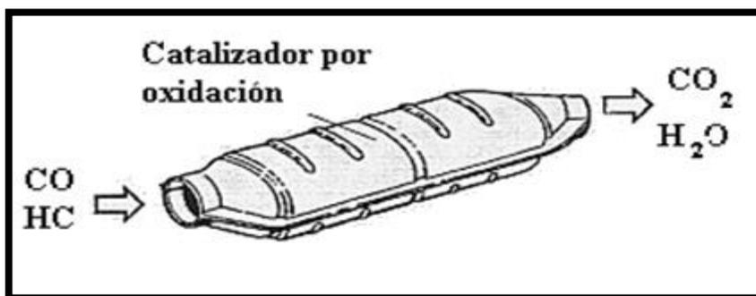
*Nota:* En el gráfico se puede observar un catalizador de dos vías, donde se produce la reacción química de oxidación del CO y HC; transformándolos a su salida en CO<sub>2</sub> y H<sub>2</sub>O. (Vázquez, s.f.)
