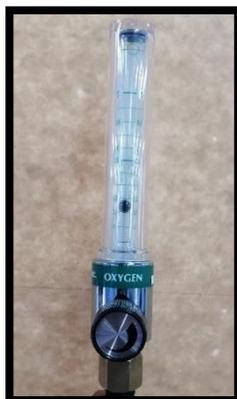
*Nota:* En el gráfico se puede observar un flujómetro de pared con una escala de  $1 \frac{l}{min}$  ideal para el control de flujo de los gases durante el proceso de regeneración del convertidor catalítico.
