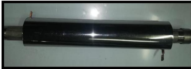
*Nota:* En el gráfico se puede observar el recubrimiento de la resistencia eléctrica y el tubo reactor con la lámina de acero inoxidable.
