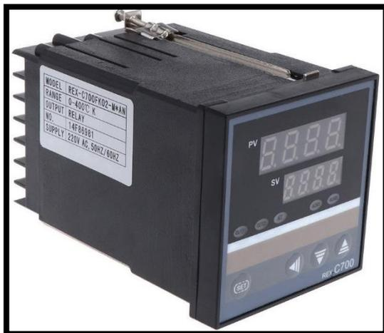
*Nota:* En el gráfico se puede observar el controlador de temperatura, el cual permite visualizar las lecturas de temperatura enviadas por de las termocuplas y modificar los rangos de temperatura de trabajo.
