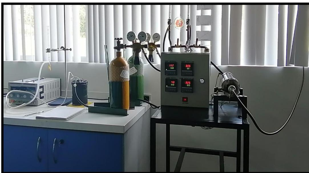
*Nota:* En el gráfico se puede observar el sistema de tratamiento de monolitos, para el proceso de oxidación y reducción de las muestras del convertidor catalítico automotriz.
