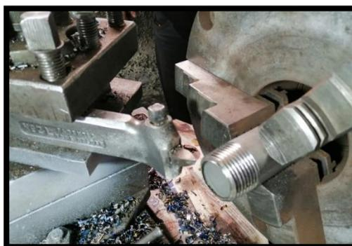
*Nota:* En el gráfico se puede observar el proceso de maquinado de una rosca cónica de 8 hilos en uno de los extremos del tubo reactor para la estanqueidad del sistema.
