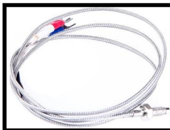
*Nota:* En el gráfico se puede observar una termocupla de contacto tipo "K", la cual mide valores de temperatura de 0 °C a 600 °C
