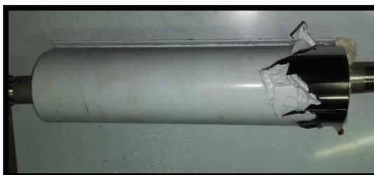
*Nota:* En el gráfico se puede observar el recubrimiento final del tubo reactor con una lámina de acero inoxidable
