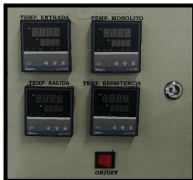
*Nota:* En el gráfico se puede observar el interruptor de encendido/apagado junto con los cuatro controladores de temperatura ensamblados al gabinete metálico, los cuales permitieron visualizar y monitorear las temperaturas de trabajo.
