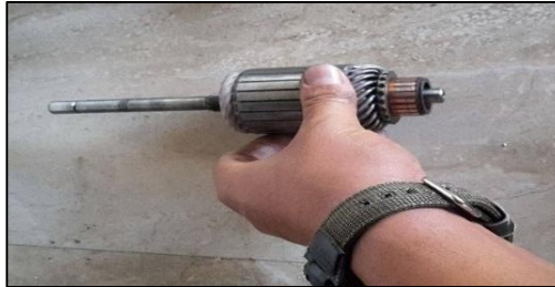
Figura No. 82. Armadura.
