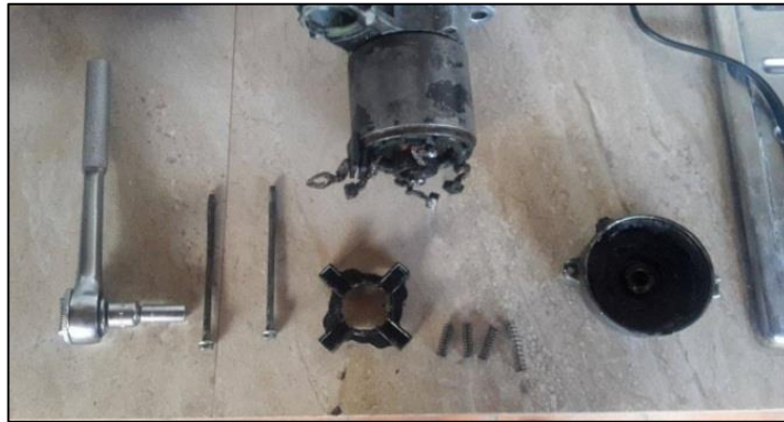
Figura No. 73. Desmontaje del porta escobillas
