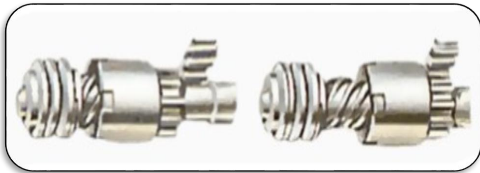
Figura No. 15. Acoplamiento del Bendix al volante de inercia
