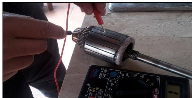
Figura No. 92. Continuidad entre conmutador y cuerpo
