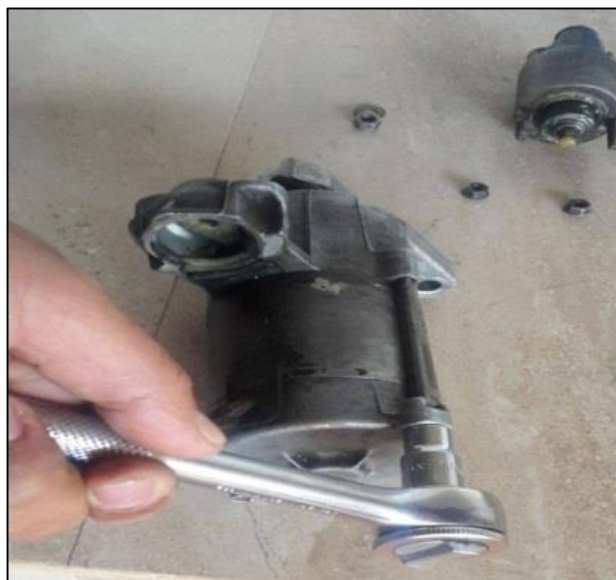
Figura No. 72. Desmontaje del motor
