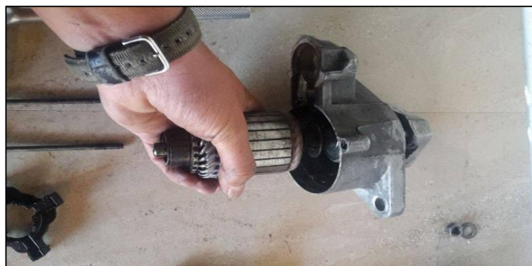
Figura No. 78. Armadura.
