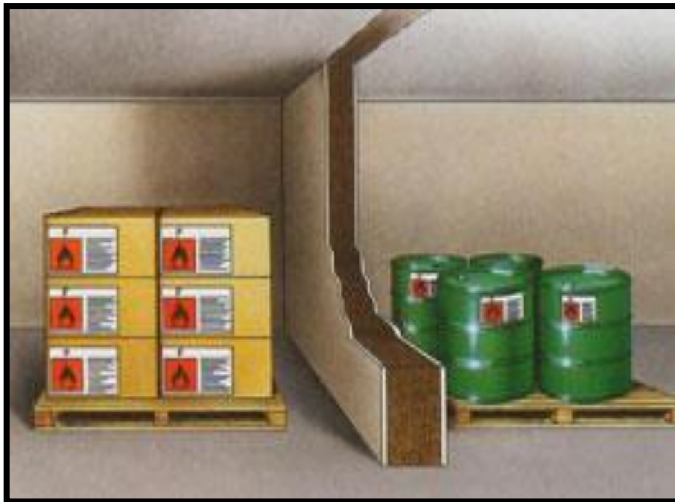
Figura N. 5.3 Almacenamiento Separado de Productos Incompatibles Fuente: Manual de Seguridad y Salud Ocupacional de Roberto Laborda
