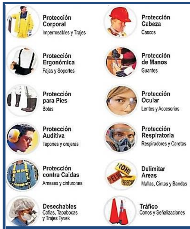
Figura 3.16 Equipos de protección
