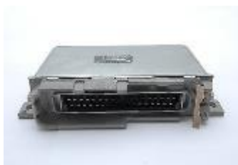
Figura 10. Módulo de Control Electrónico
