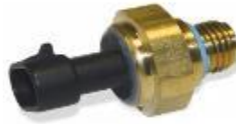
Figura 17. Sensor de Presión de aceite del Motor
