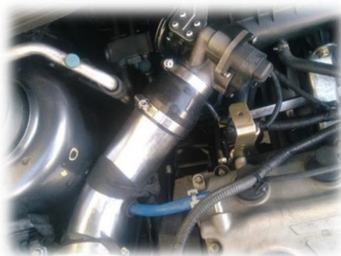
Figura 47. Colocación de intake
