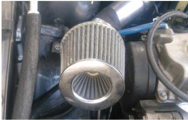
Figura 48. Colocación de filtro cónico
