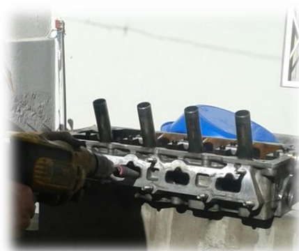
Figura 38. Proceso de porteado
