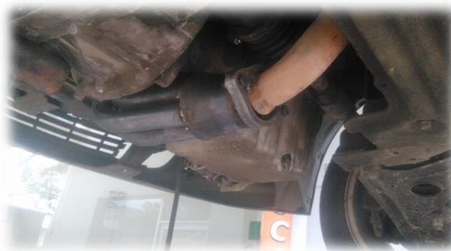
Figura 54. Instalación de header 4-1
