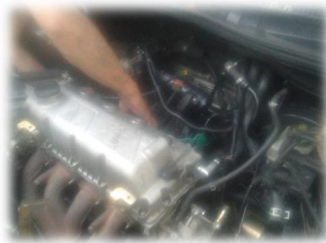
Figura 45. Colocación del tapa válvulas
