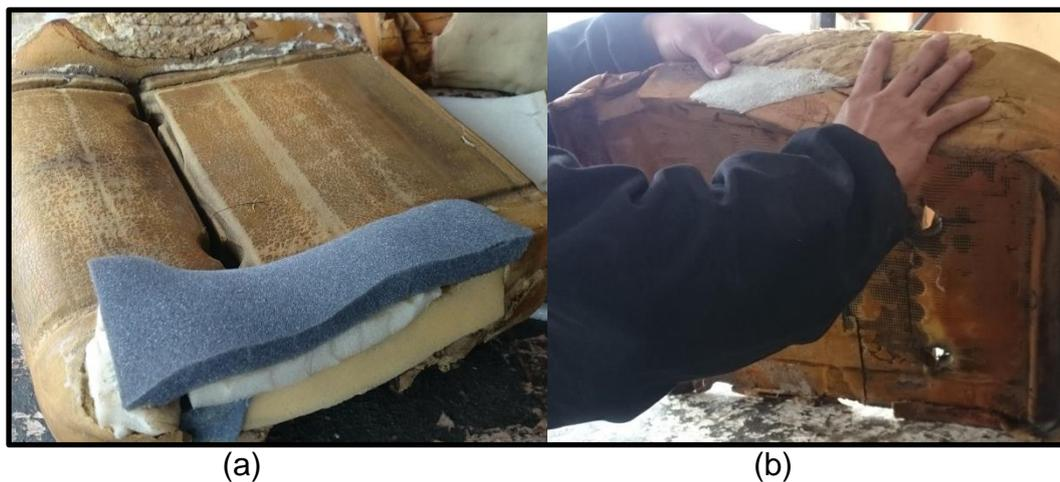
**Figura 35 Colocación de capas de esponjas y moldeado**
