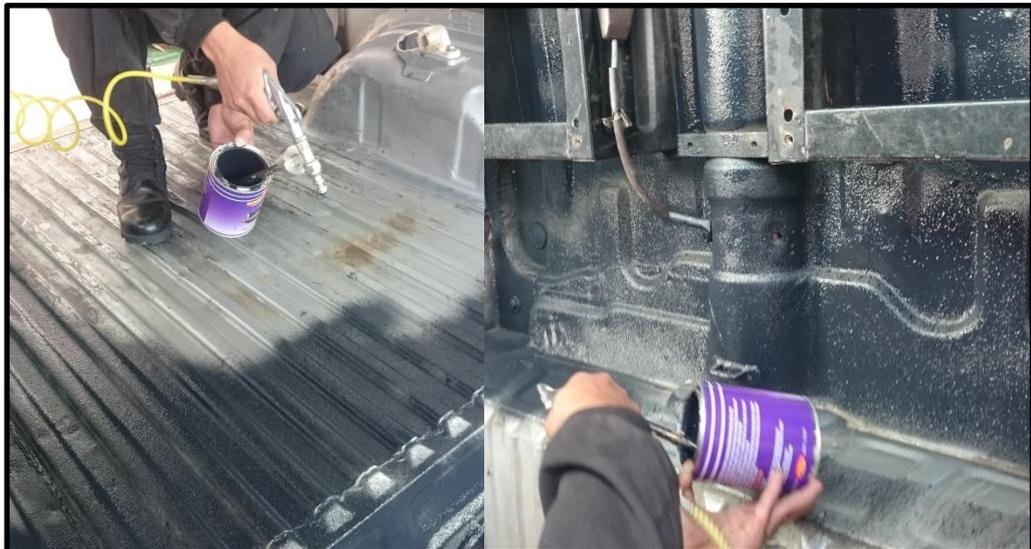
**Figura 29 Aplicación de Bate Piedra hacia la parte posterior**
