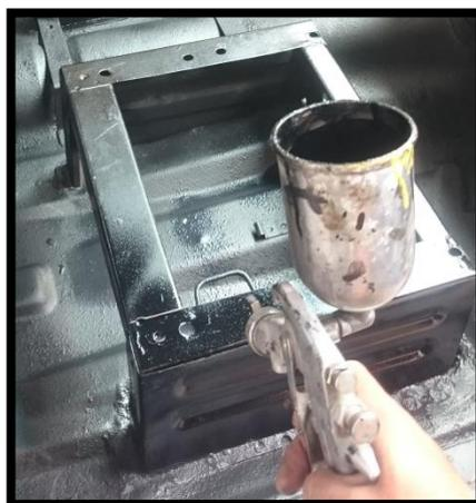
Figura 32 Aplicación de pintura en las bases de asientos
