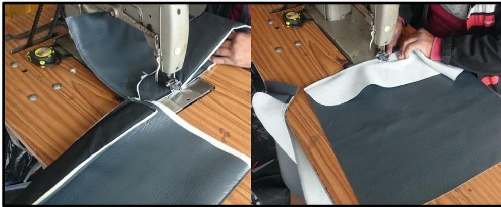
**Figura 42 Unión de las aletas con la parte central de las almohadillas**
