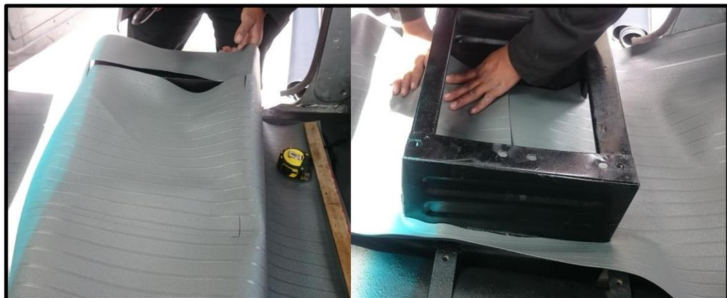
**Figura 53 Corte del material para la base de los asientos**
