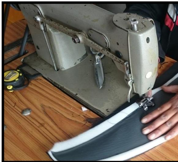
**Figura 13 Máquina de coser de tipo industrial**
