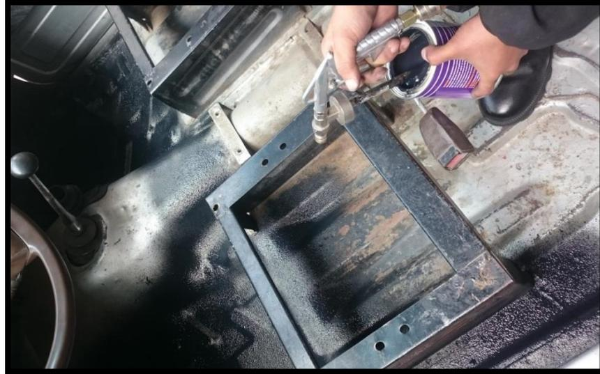
**Figura 28 Aplicación del Bate piedra (parte delantera)**
