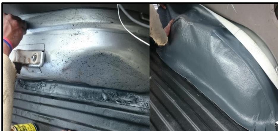
**Figura 57 Montaje del material sobre los bordes de las llantas**
