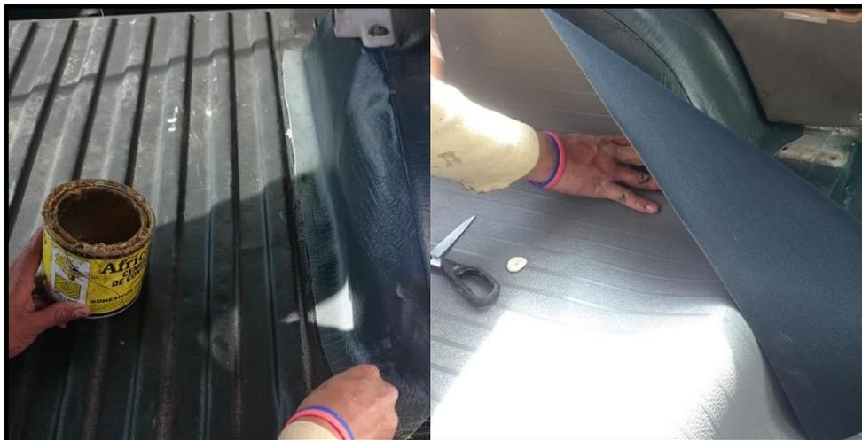
**Figura 58 Colocación de pegamento y corte de excedente de material**
