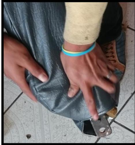
**Figura 46 Colocación de forros de la esponja del espaldar**
