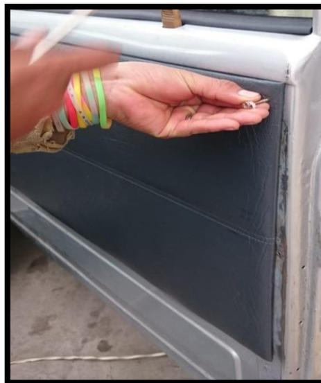
**Figura 65 Colocación de los paneles**
