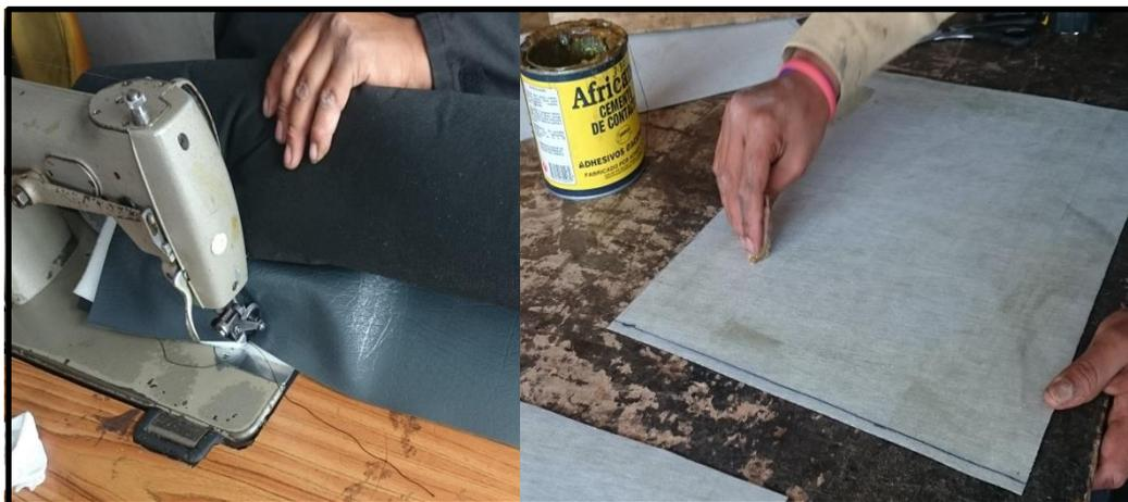
**Figura 56 Costura y colocación de pegamento**
