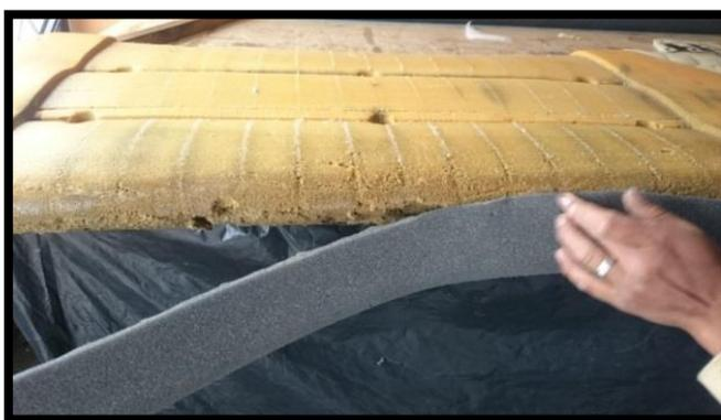
**Figura 36 Colocación de capa en el asiento posterior**
