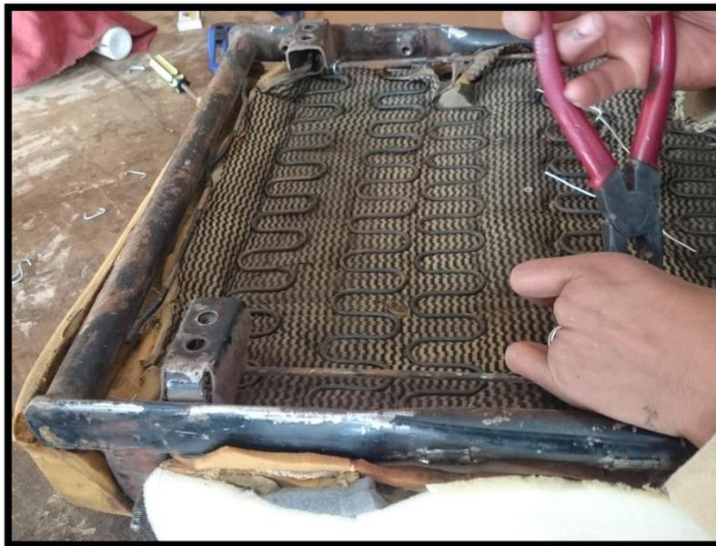
**Figura 37 Colocación de las espumas a las bases de resortes**
