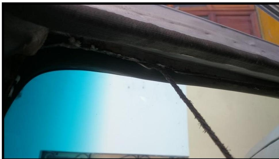
**Figura 2424 Colocación de la junta con cuerda**
