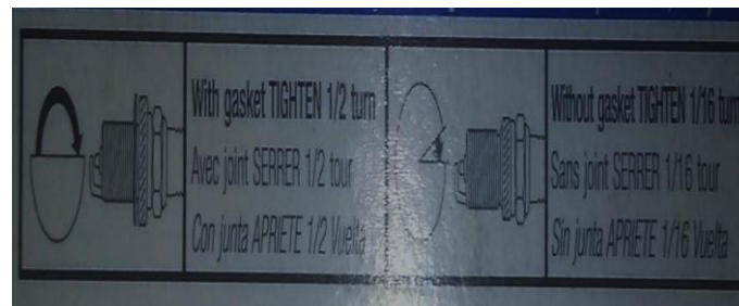
Figura 120 Apriete De Las Bujías Según El Fabricante
