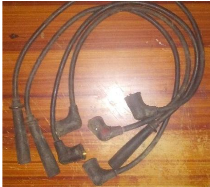
Figura 117 Cables De Alta Tensión Motor G10
