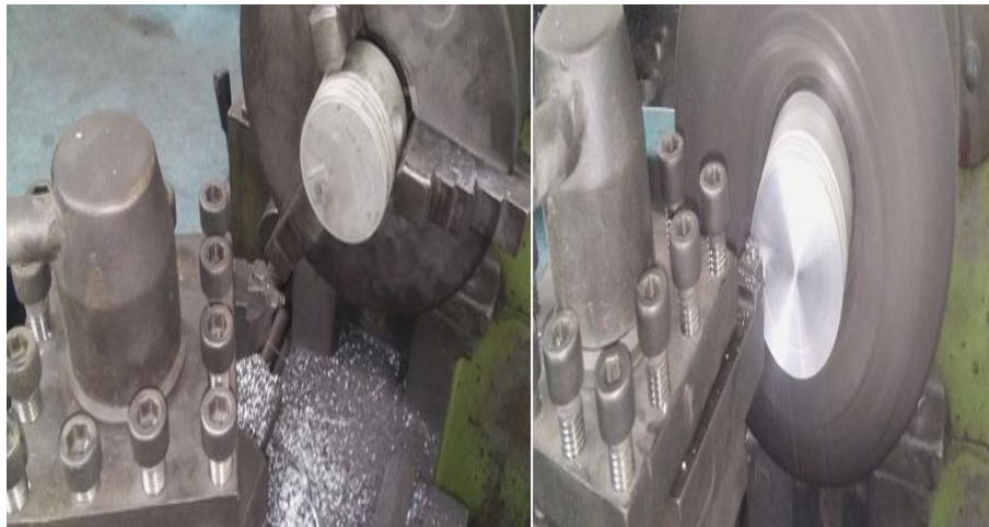
Figura 81 Pistón 4g15 Trabajado En El Torno
