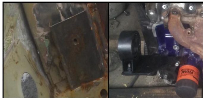
Figura 140 Refuerzo De Carrocería Y Base Sujeta Al Motor
