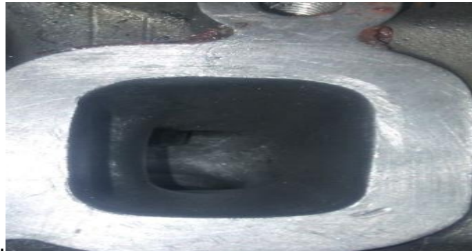
Figura 95 Mecanizado De Conducto De Escape Con Piedras Abrasivas
