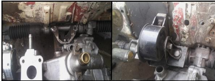
Figura 130 Base Posterior Original Y Elaborada Para La Adaptación
