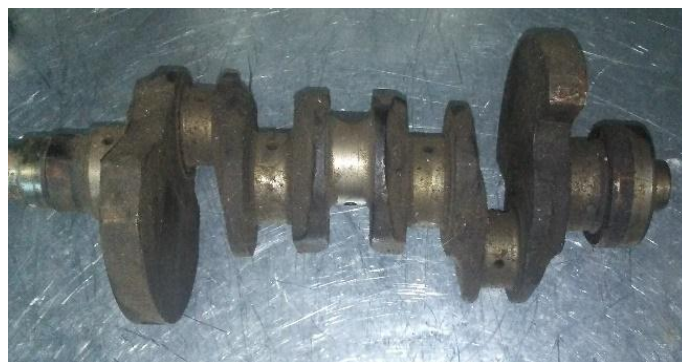
Figura 75 Cigüeñal Previo A Su Rectificación
