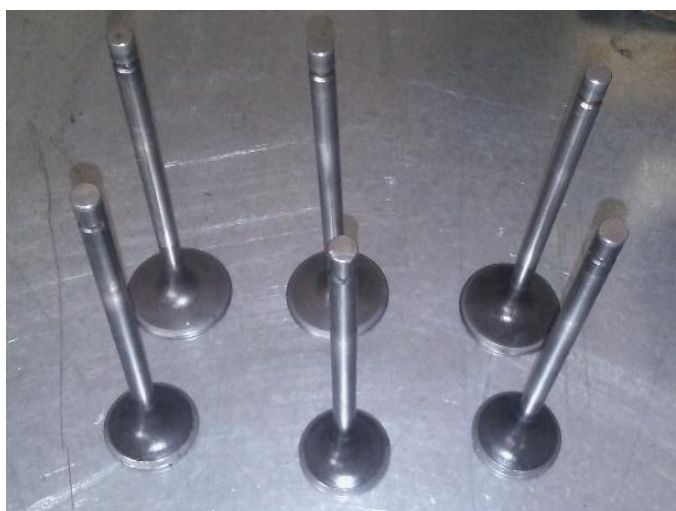
Figura 105 Juego De Válvulas Motor G16a Listas Para Montar
