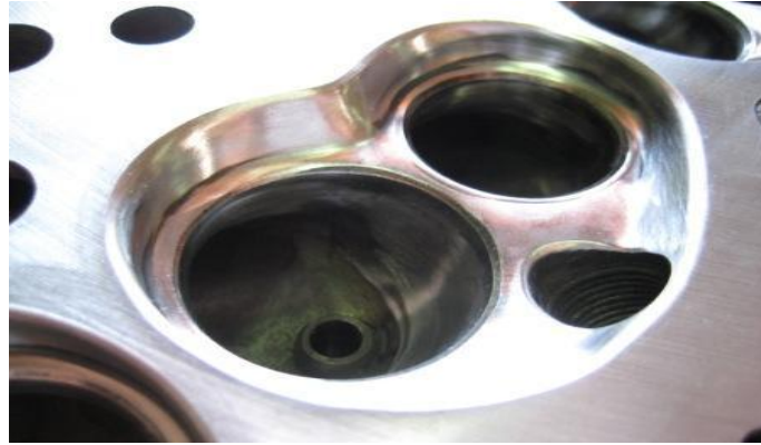
Figura 24 Cámara De Combustión Pulida
