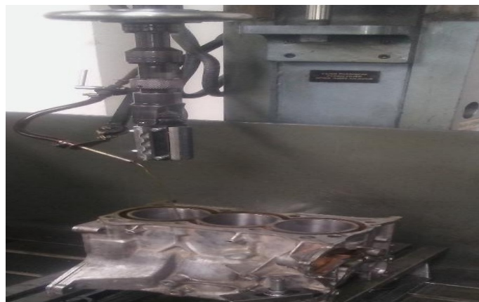
Figura 70 Pulido y Bruñido De Cilindros
