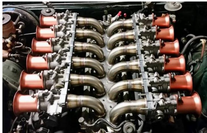
Figura 34 Conductos De Admisión Con ITB'S
