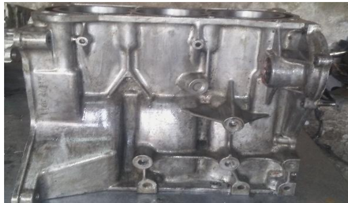
Figura 71 Block Previo Al Trabajo De Limpieza
