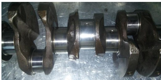
Figura 76 Cigüeñal Rectificado a + 0.25 mm
