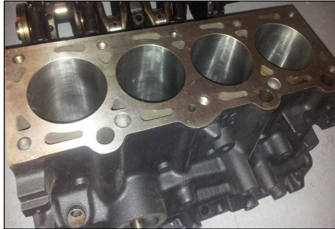
Figura 14 Bloque De Cilindros Rectificado
