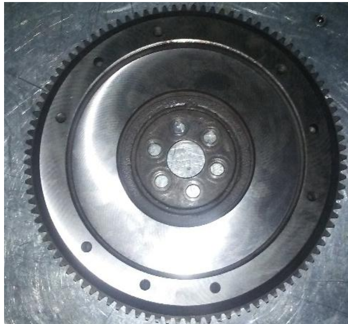
Figura 100 Volante Motor Rectificado
