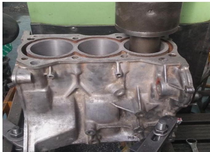
Figura 69 Rectificada De Los Cilindros A 76.50 mm.
