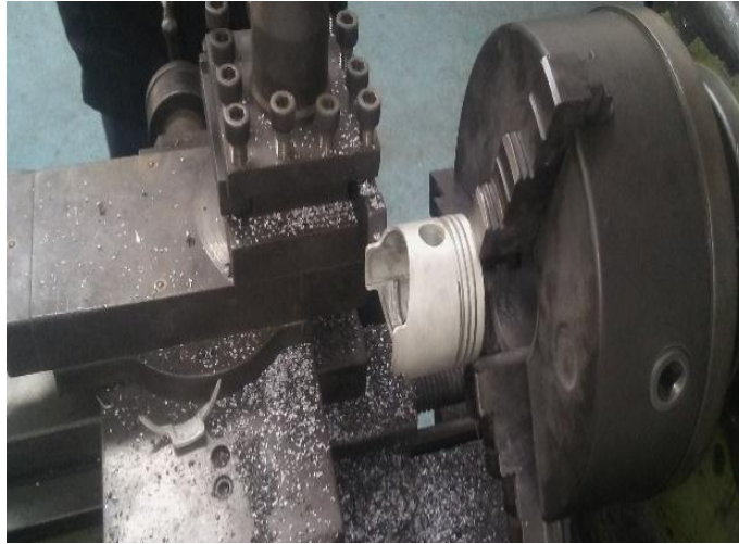
Figura 82 Pistón 4g15 En Recorte De Falda
