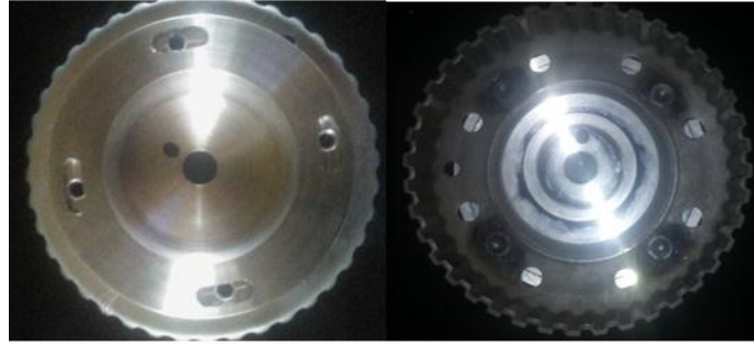
Figura 108 Polea Perforada Y Acoplada A La Pieza De Aluminio
