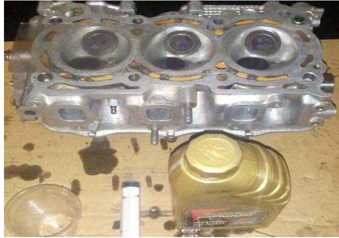
Figura 88 Materiales Para Medir Volumen Cámara De Combustión
