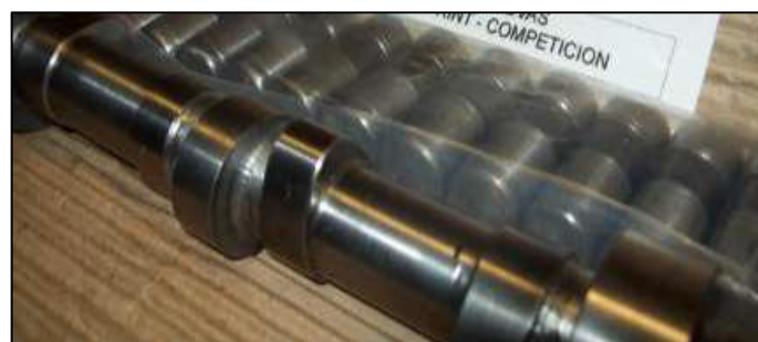
Figura 44 Árbol De Levas Para Circuitos
