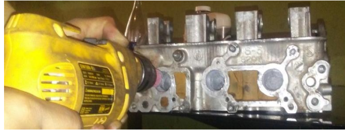
Figura 92 Mecanizado De Conducto De Admisión Con Piedras Abrasivas
