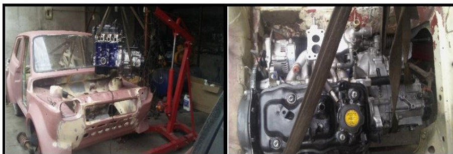
Figura 128 Motor Embancado En El Vehículo Fiat 127.
