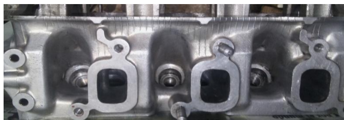
Figura 96 Conductos De Escape Porteados Y Pulidos
