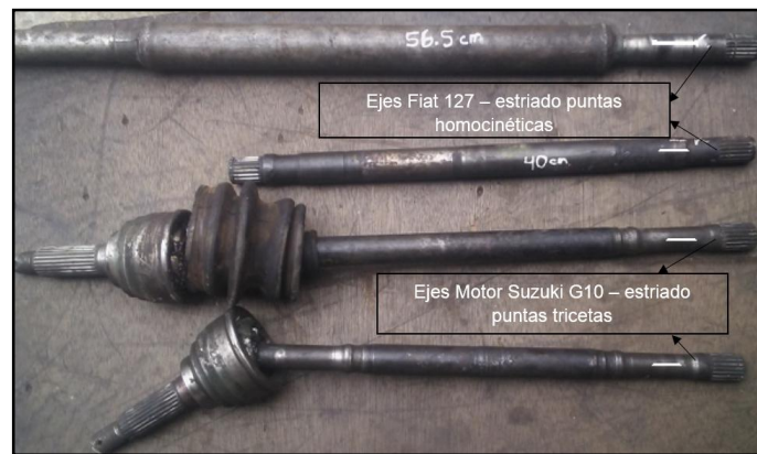
Figura 144 Semiejes Fiat 127 Y Motor Suzuki G10
