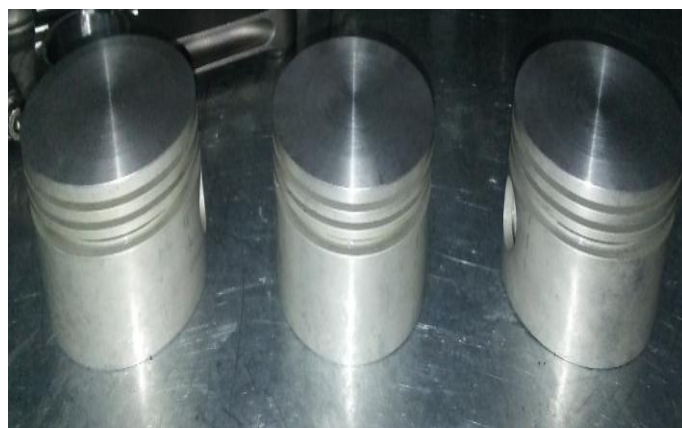
Figura 83 Juego De Pistones 4g15 Finalizado El Trabajo
