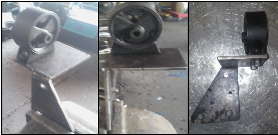
Figura 135 Base Derecha Lista Para Fijarla A La Caja De Cambios
