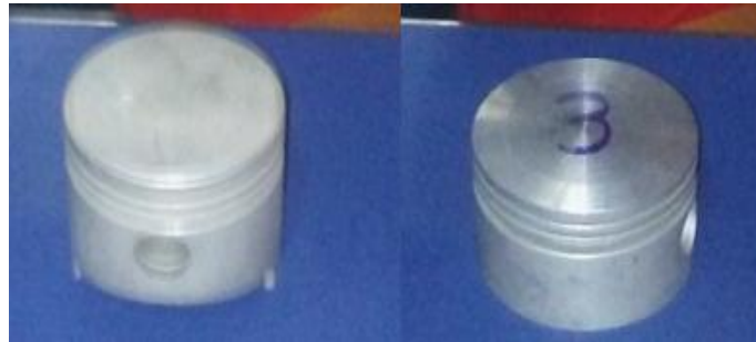
Figura 84 Pistones 4g15 Standar Y Modificado
