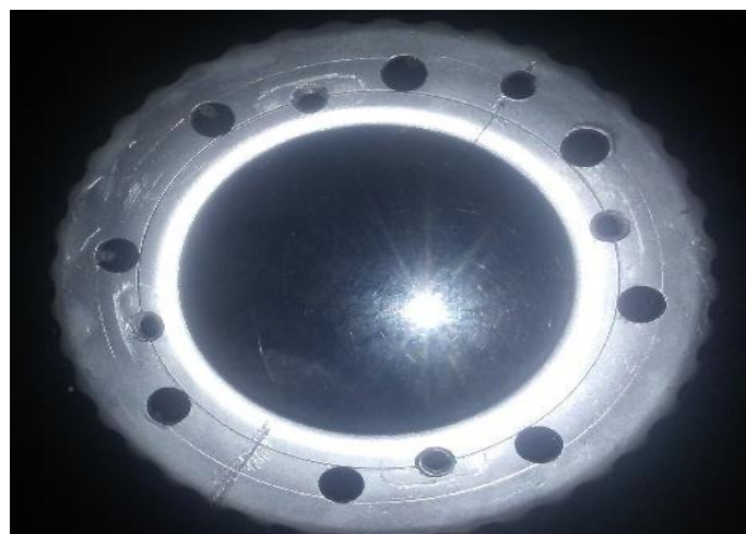
Figura 106 Polea Realizada Corte Circular
