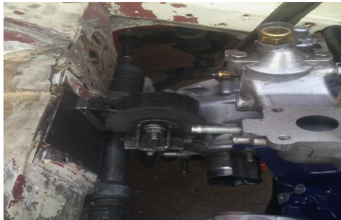
Figura 132 Base Posterior Fijada Entre Motor Y Carrocería
