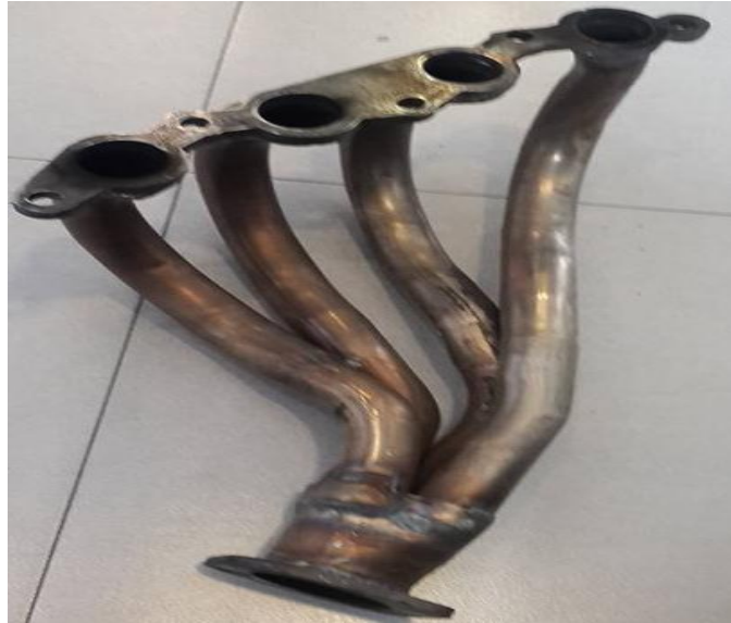
Figura 67 Header Che. Corsa Diseño 4-1
