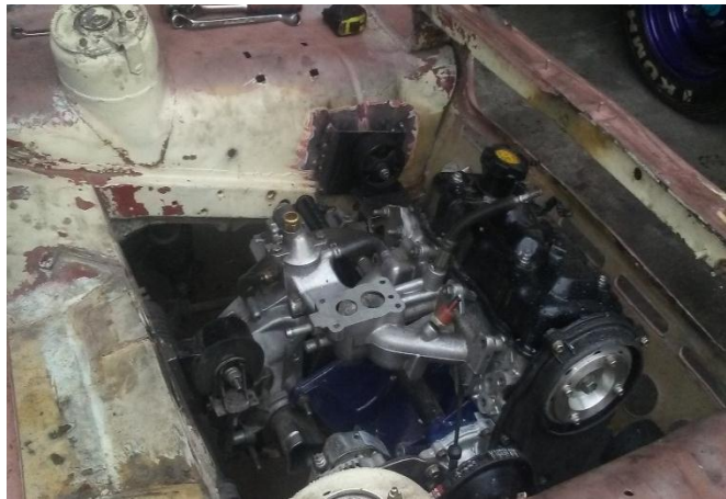
Figura 141 Motor G10 Adaptado En El Vehículo Fiat 127
