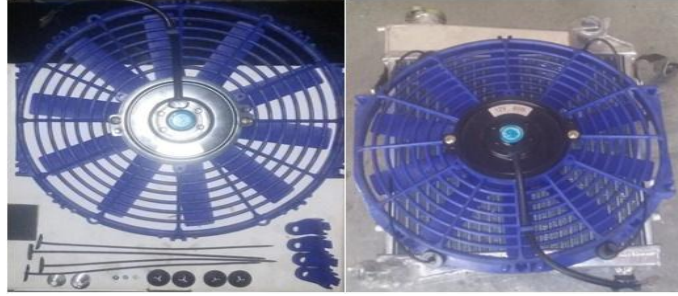
Figura 123 Electro Ventilador Junto Al Radiador
