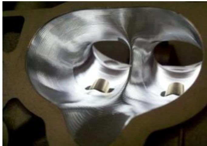
Figura 23 Pulido Conductos De Escape
