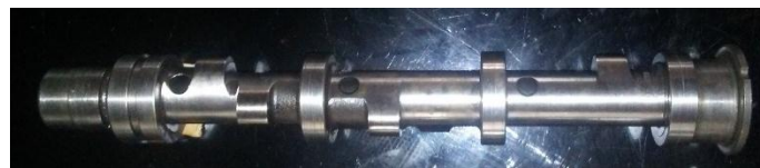
Figura 102 Árbol De Levas Motor G10 Modificado
