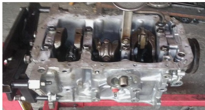
Figura 68 Block G10 Previo Al Desmontaje De Sus Elementos Internos
