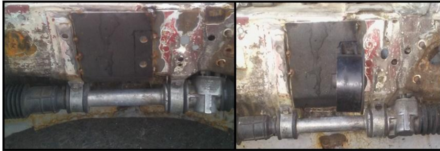
Figura 131 Refuerzo Carrocería Y Base De Caucho
