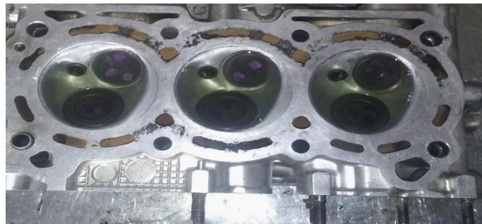
Figura 103 Prueba De Hermeticidad Cámara De Combustión
