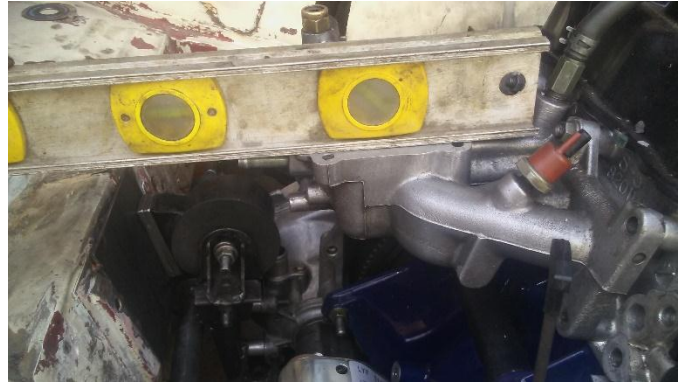
Figura 142 Motor G10 Instalado Y Nivelado
