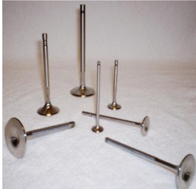
Figura 38 Válvulas Pulido Efecto Espejo
