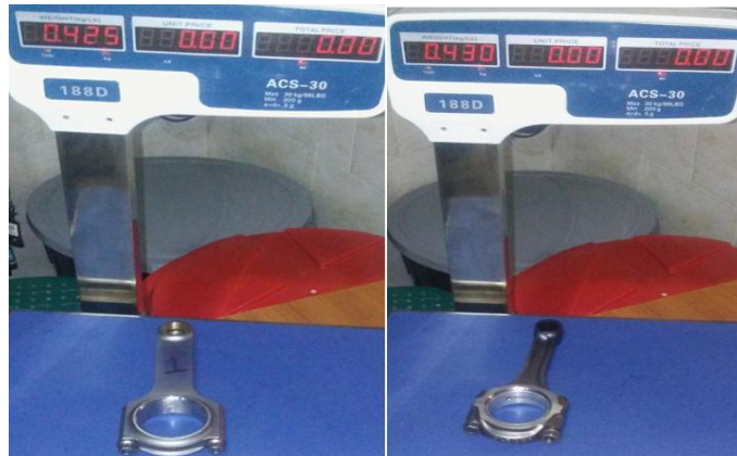
Figura 79 Pesaje De Bielas Forjadas
