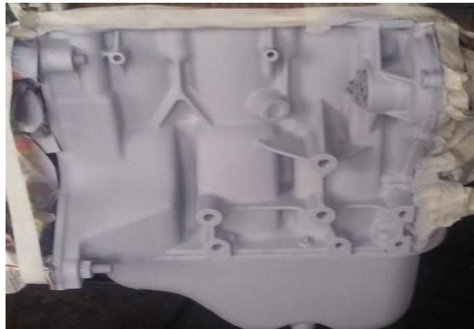
Figura 73 Block Aplicado Pintura De Fondo
