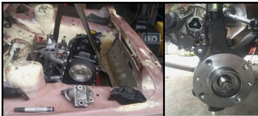
Figura 129 Motor Centrado Además Altura E Inclinación Entre Caja De Cambios Y Manzana.
