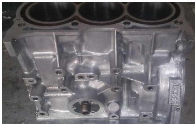
Figura 72 Block Limpio Listo Para Armarlo
