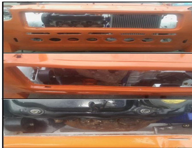
Figura 126 Distancia Entre Múltiple De Escape Y Carrocería
