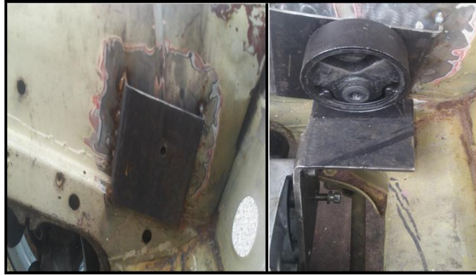
Figura 136 Refuerzo De Carrocería Y Base Instalada En La Caja De Cambios
