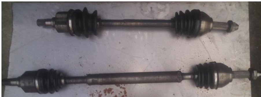
Figura 147 Semiejes Con Sus Tricetas, Juntas Homocinéticas Y Guardapolvos.
