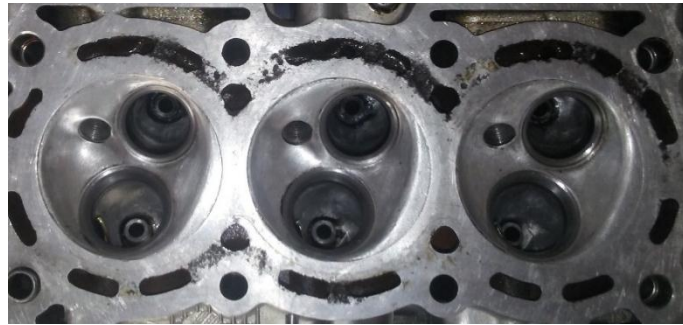
Figura 98 Cámaras De Combustión Limpias Y Pulidas
