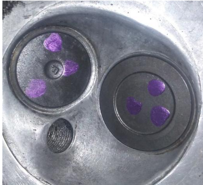
Figura 99 Asientos De Válvula Rectificados
