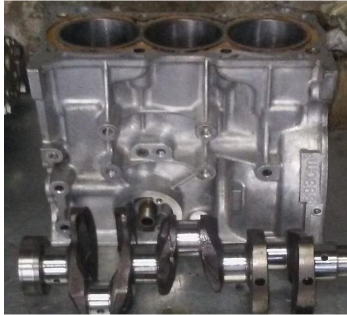
Figura 77 Cigüeñal Listo Para Montaje En El Block
