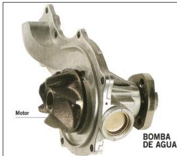
Figura 58 Bomba De Agua
