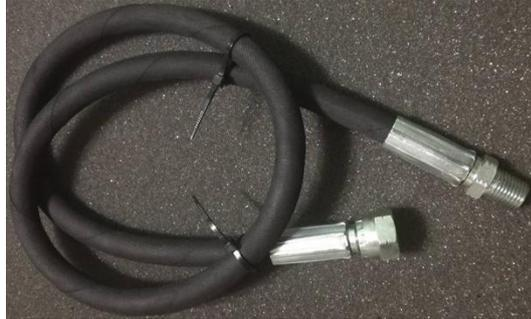
**Figura 34 Manguera para adaptar acoples.**
