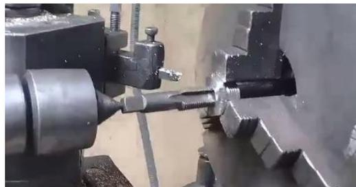
**Figura 58 Roscado de la tapa con el machuelo adaptado en el contrapunto del torno.**
