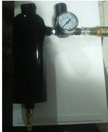
**Figura 53 Producto final limpiador de inyectores tipo Canister.**
