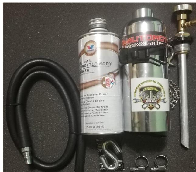
**Figura 61** Equipo descarbonizador para motor y sistema de admisión.
