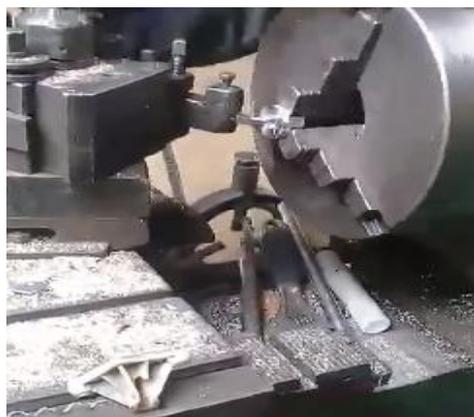
**Figura 56 Puesta en el torno de la tapa para aplanar superficie.**
