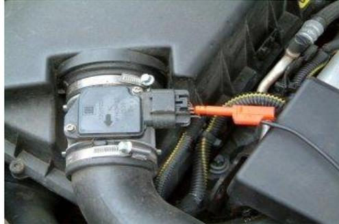
**Figura 21 Medidor del caudal de aire.**
