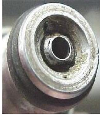
**Figura 10 Inyector con válvula de bola.**
