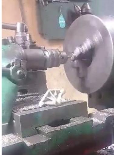
**Figura 57 Perforación de la tapa con el machuelo en el contrapunto del torno.**
