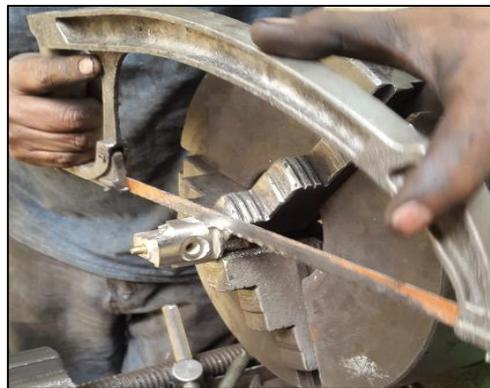
**Figura 44 Corte de la tapa del limpiador de inyectores.**
