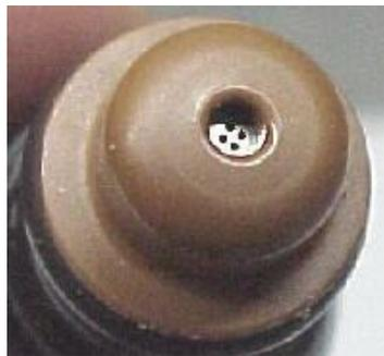
**Figura 12 Inyector con válvula tipo disco.**
