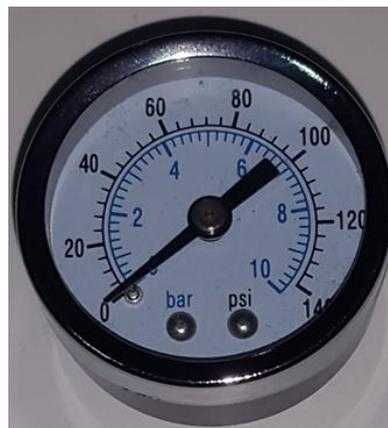
**Figura 31 Manómetro de presión de aire.**
