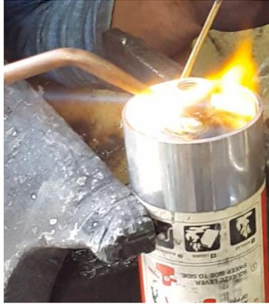
**Figura 52 Adaptación del acople de  $\frac{1}{4}$  con la suelda de bronce.**
