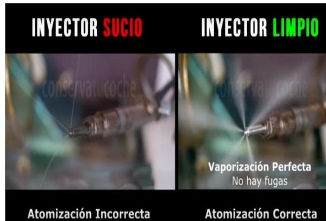
**Figura 13 Atomización incorrecta y correcta de un inyector.**
