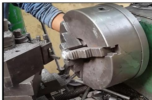
**Figura 45 Colocación en el torno de la tapa para darle un acabado plano con la cuchilla.**
