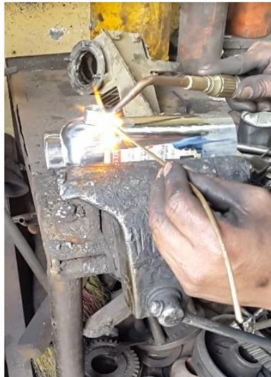
**Figura 49 Adaptación del acople de  $\frac{1}{4}$  con la suelda de bronce.**
