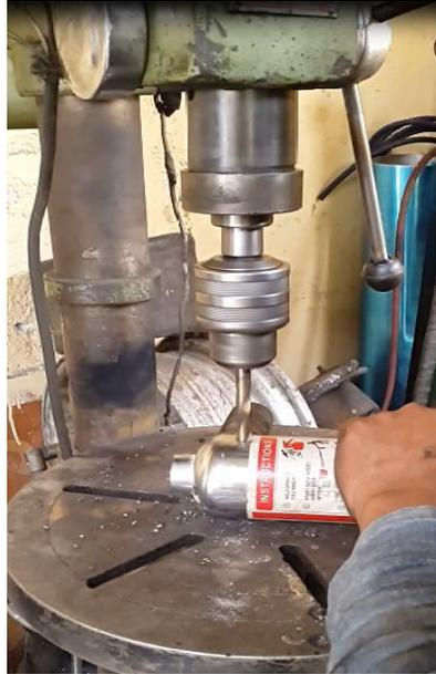
**Figura 48 Perforación con la ayuda de una fresadora en el cilindro.**
