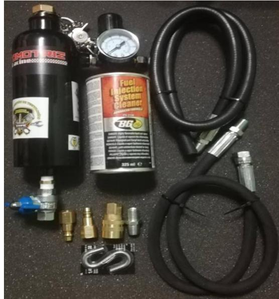
**Figura 60** Equipo del limpiador de inyectores tipo Canister.
