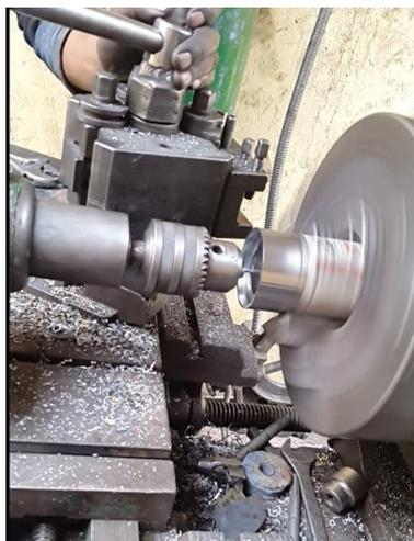
**Figura 51 Perforación del cilindro con broca en el torno.**
