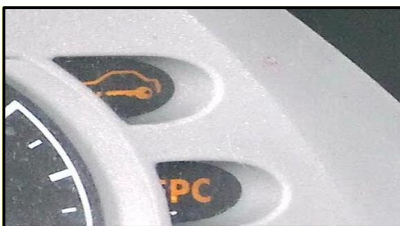
**Figura 47 Luz testigo del inmovilizador encendida**
