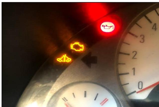
**Figura 66 Luz testigo de Chevrolet Corsa Evolution del inmovilizador encendida**
