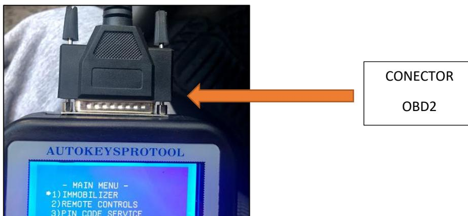
**Figura 59 Comprobación de una conexión correcta**
