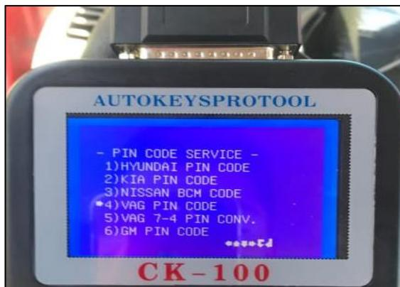
**Figura 28 Funciones y versiones de autos que son compatibles con el equipo programador**
