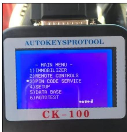
**Figura 27** Funciones principales del equipo programador
