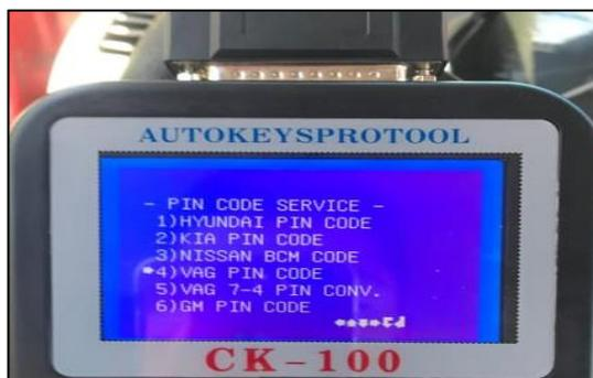
**Figura 44 La función VAG es compatible para el volkswagen Fox en el momento de extraer el código del inmovilizador**
