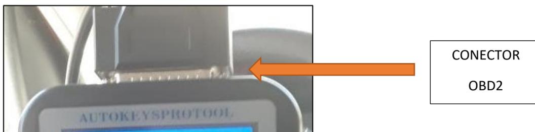
**Figura 26** Forma de correcta de conexión
