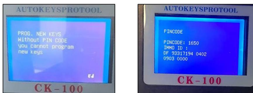
**Figura 69 Código del inmovilizador insertado para comenzar a codificar el transponder**
