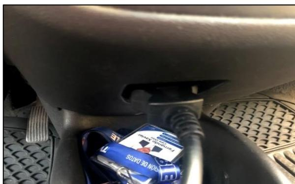
**Figura 58 Localización del conector OBD2 en Chevrolet Corsa**
