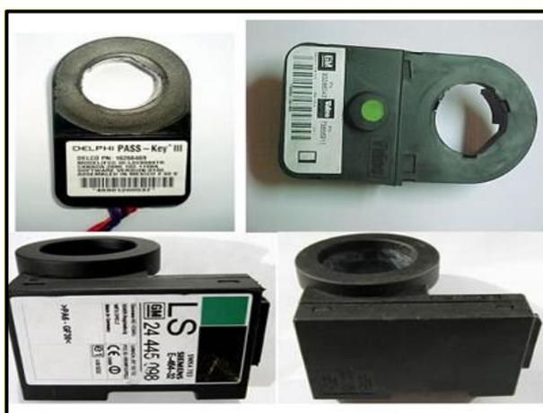
**Figura 10 Módulos de control acoplado en el conmutador de arranque**
