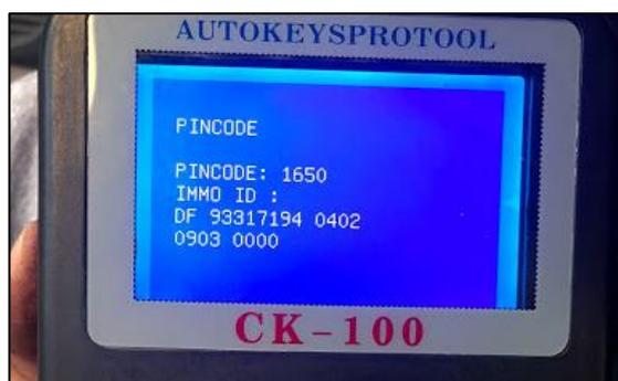
**Figura 65 Extracción correcta del código de Chevrolet Corsa Evolution**
