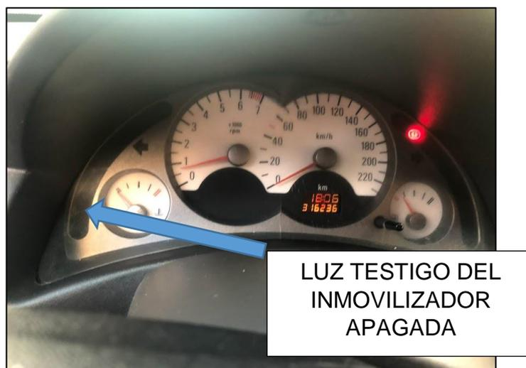
**Figura 73 Luz testigo del inmovilizador apagada
