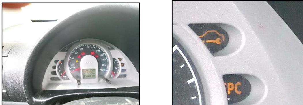
**Figura 7 Localización del testigo del inmovilizador**
