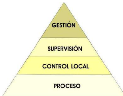
Figura. 3.8.1. Modelo piramidal de automatización
