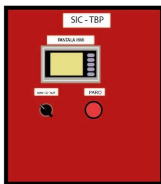
**Figura 95** Esquema tablero de control SIC-TBP
