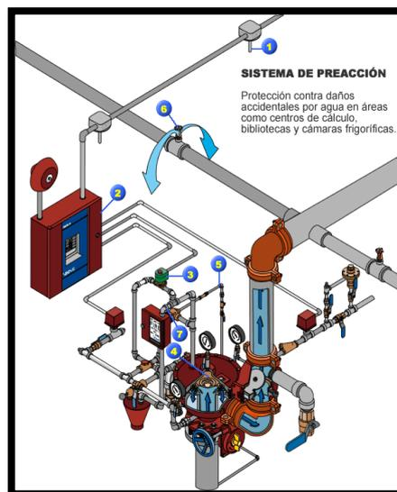
**Figura 2 Sistema de preacción**
