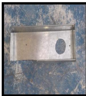
**Figura 85 Mecanizado de tol galvanizado**
