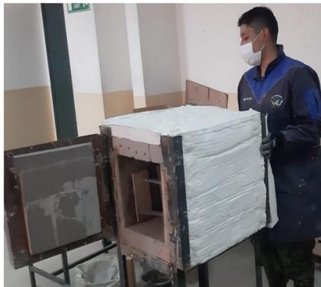
*Nota.* La manta cerámica cubre todas las paredes del horno así se logra aislar el calor producido en el interior y aprovechar la energía en el interior.
