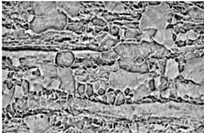
*Nota.* La figura muestra cómo termina el acero después de que se aplica el tratamiento térmico del recocido. Tomado de (Campillo, 2009)
