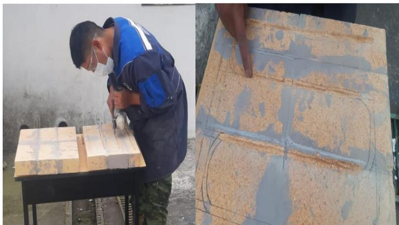
*Nota.* Es necesario realizar canales para fijar la resistencia que genera el calor.
