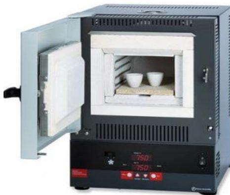
*Nota.* La imagen muestra un horno mufla con cámara interna pequeña. Tomado de (TP-Laboratorio Químico, 2015)
