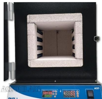
*Nota.* La imagen muestra la cámara interior de un horno mufla con resistencias ubicadas en las paredes laterales. Tomada de (Acequilabs, 2018).
