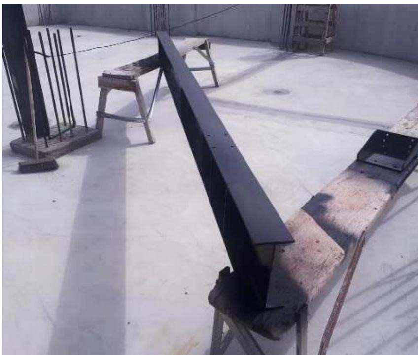
**Validación de la viga.** En el catálogo DIPAC de este tipo de perfil el fabricante menciona que estos son fabricados con aceros de calidad ASTM A36 el cual presenta en este caso un resistencia mecánica de 370 MPa a 520 MPa y un punto de fluencia
