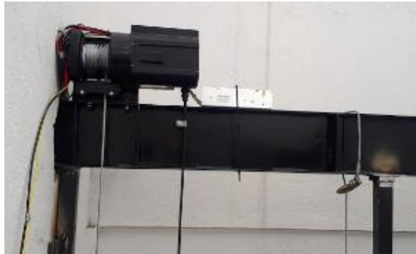
**Configuración de poleas.** Con el fin de garantizar un desplazamiento suave seguro y eficiente además para alargar la vida útil del grupo tractor el sistema cuenta con una configuración de polea móvil o configuración 2 a 1 la cual se ejemplifica en la Figura 45 la cual reduce el esfuerzo que tiene que hacer el grupo tractor.
