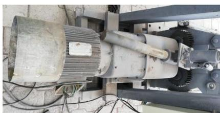
Nota: Motorreductor empleado para transmitir movimiento a los ejes fijos inferiores de la baroladora.
