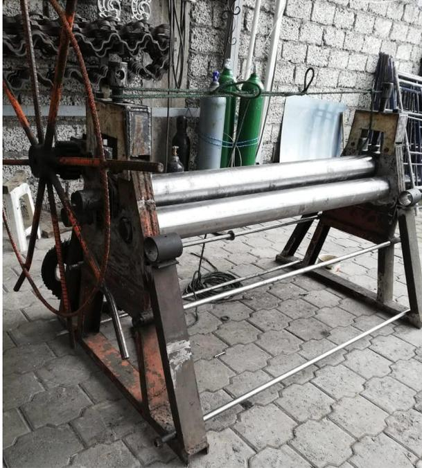
Nota: Baroladora manual de transmisión de movimiento mediante un volante para la deformación de láminas de acero.
