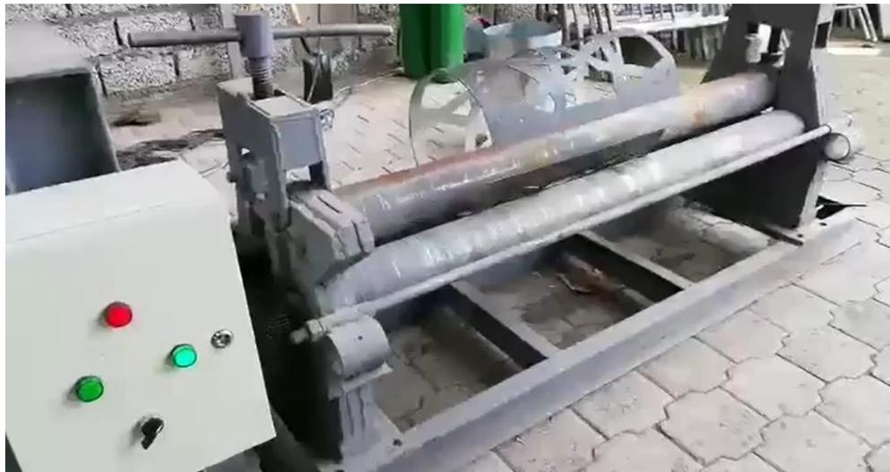
Nota: Comprobación de rozamiento entre rodillos superiores e inferiores.
