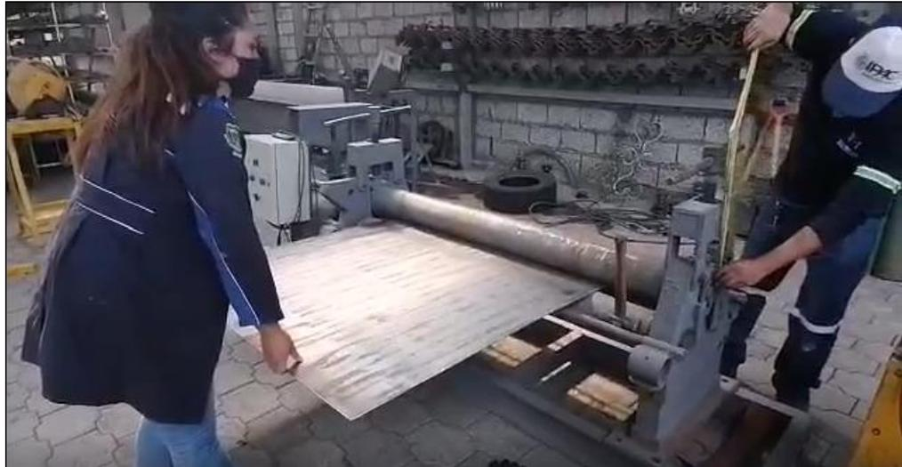
Nota: Colocación de la lámina entre los rodillos superiores e inferiores para proceso de barolado.
