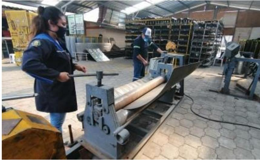
Nota: Proceso de barolado de una lámina de 3mm en forma de curva.
