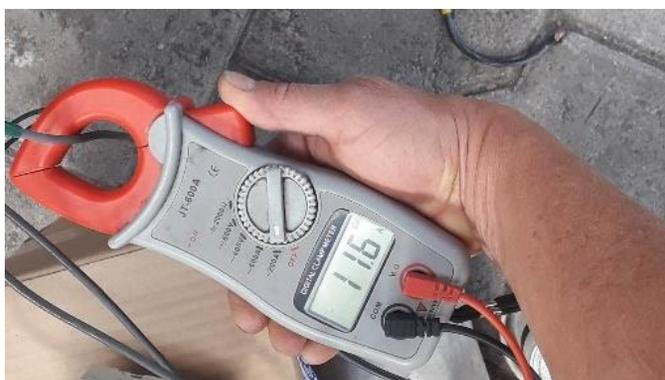
Nota: Toma de medidas en la línea R del motorreductor para verificación de los amperajes.
