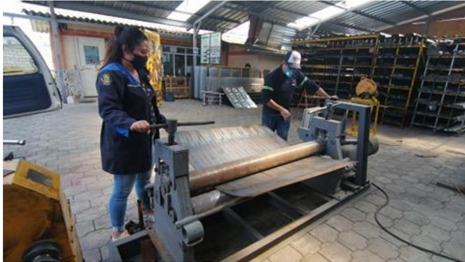
Nota: Proceso de barolado de una lámina de 3mm de espesor de dimensiones de 1220 x 1220 mm en sentido horario.
