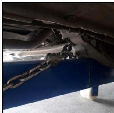
Nota: Sujeción mediante cadenas al chasis del vehículo
