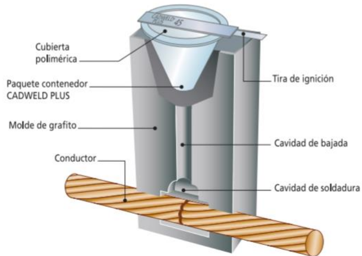
Figura 28. Componentes de la soldadura CADWELD PLUS Fuente: (ERICO, 2005)
