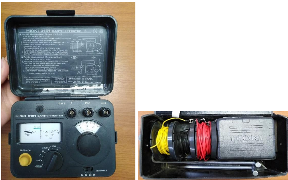
Figura 62. Telurómetro analógico HIOKI “3151 EARTH HiTESTER”
