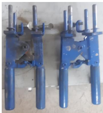
Figura 98. Pinza para molde Cadweld
