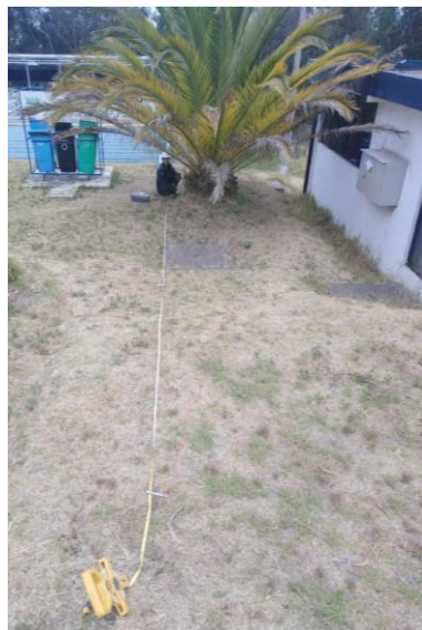
Figura 65. Alineación de picas auxiliares
