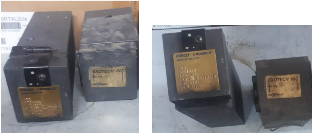
Figura 95. Moldes de grafito para suelda exotérmica
