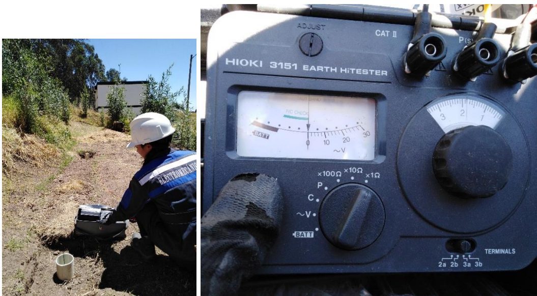
Figura 124. Medición de malla MTCI
