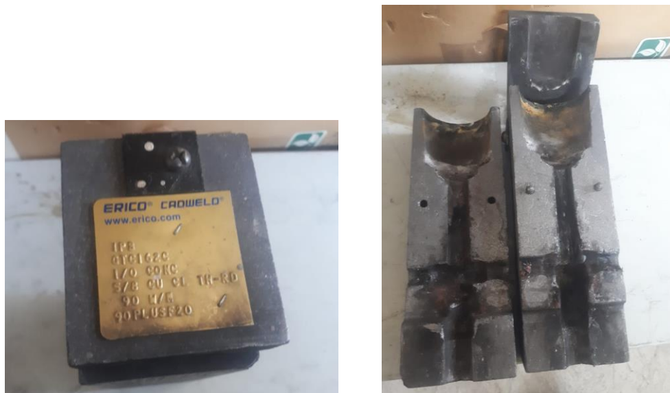
Figura 96. Molde de grafito para suelda con varilla
