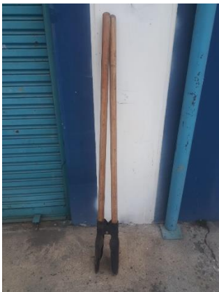
Figura 93. Excavadora manual de hoyos
