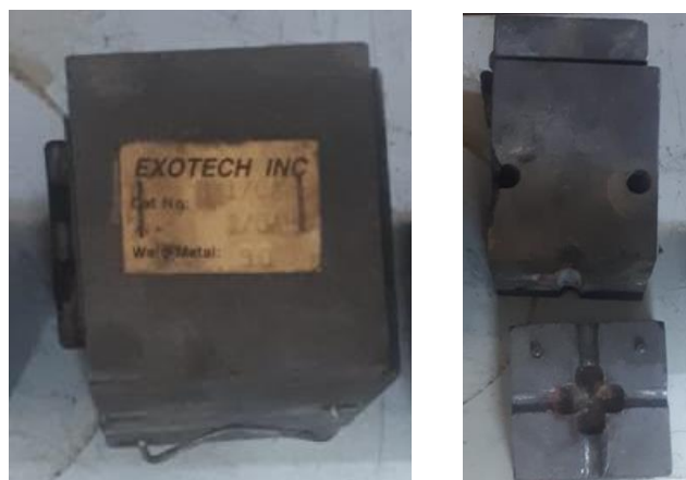
Figura 97. Molde de grafito para suelda entre conductores
