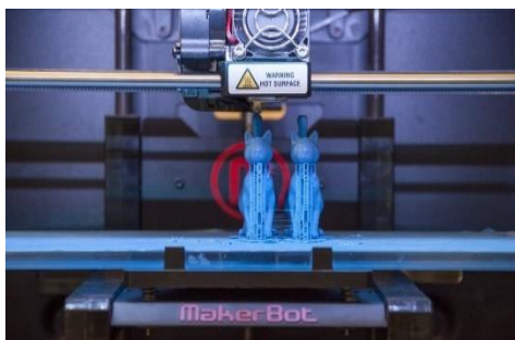
Figura 20. Impresión con material fundido.
