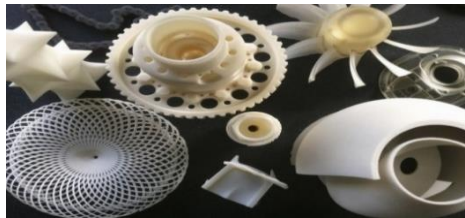
Figura 22. Impresión por láser.
