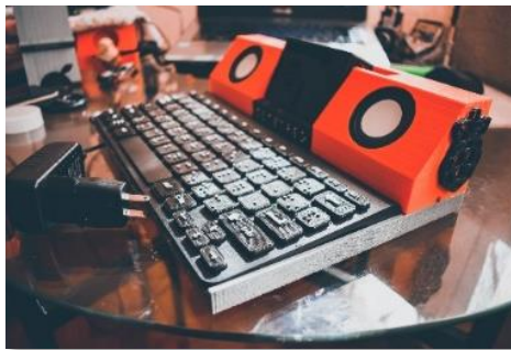
Figura 38. Cuerpo total adjunto en 3D y electrónica (teclado, parlantes, raspberry pi).
