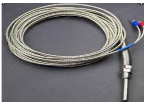
Figura 7. Termocupla de 2 hilos
