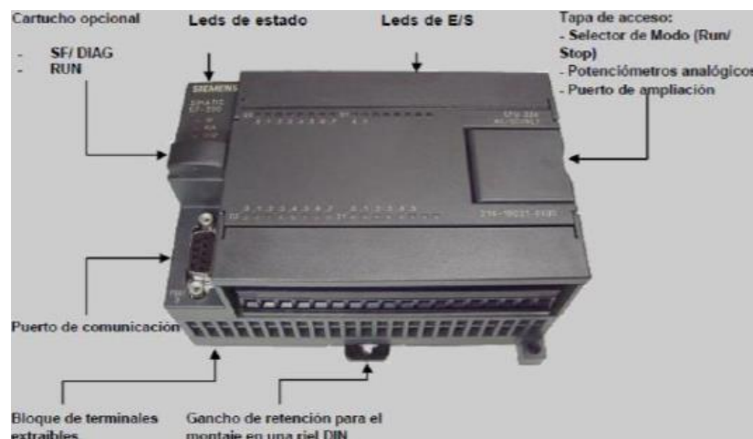
Figura 17. PLC de Marca Siemens
