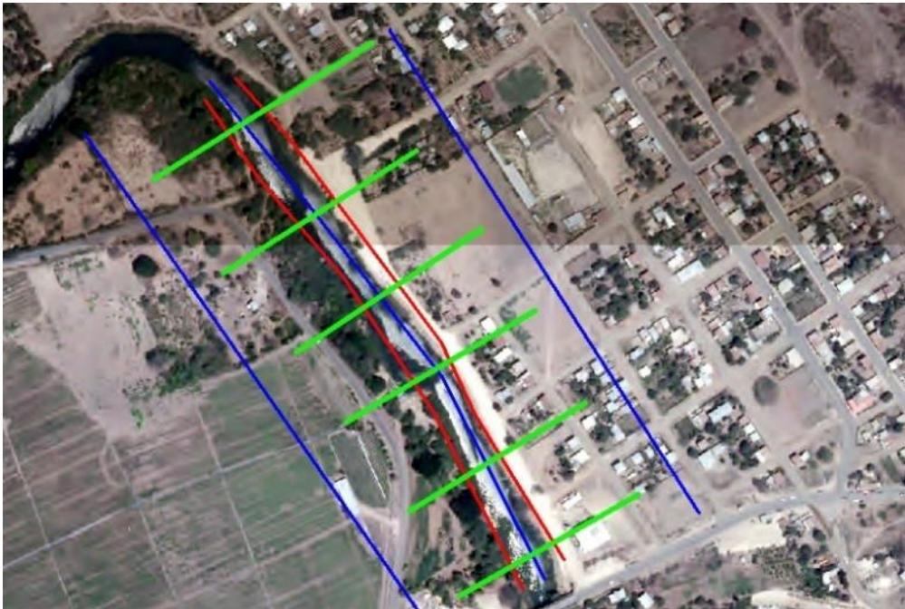
Cuando ya se creen las secciones transversales se procede a generar el modelo 3D para el cauce, dirección y secciones; cuando este procedimiento haya finalizado los datos están listos para exportar al software HEC-RAS
