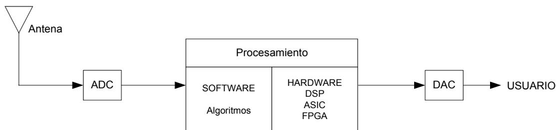
Figura. 5.1. Diagrama de bloques de un sistema basado en Software Radio<sup>26</sup>
