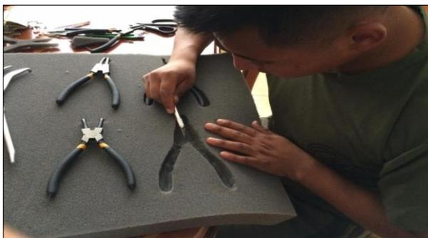
**Figura 39. Elaboración de molde para herramientas**
