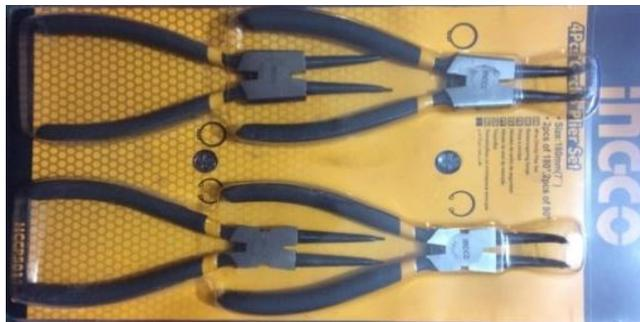
**Figura 28. Cuatro tipos de pinzas para seguros**
