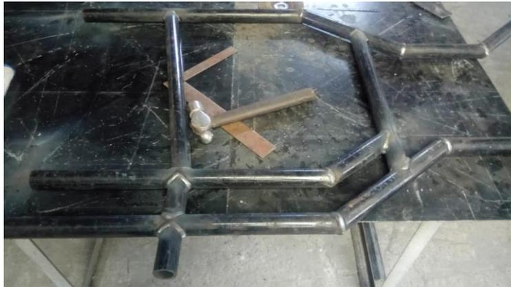
**Figura 27 Sueldas terminadas en el bastidor**
