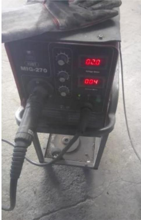
**Figura 25 Equipo para suelda MAG**
