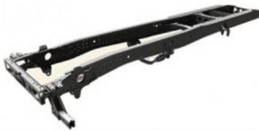
**Figura 1 Bastidor en escalera o H**
