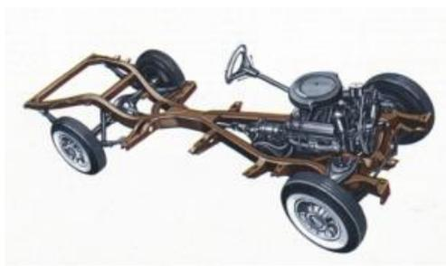
**Figura 2 Bastidor en X o columna**
