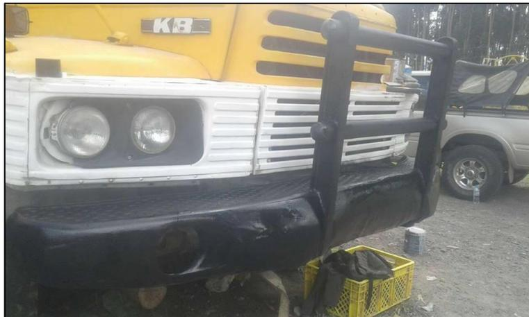
**Figura 29 Guardachoque reparado.**
