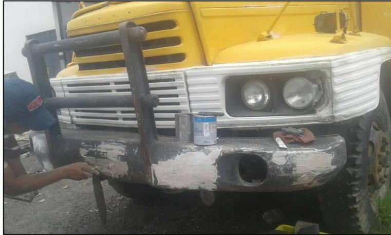
**Figura 28 Reparación del guardachoque.**
