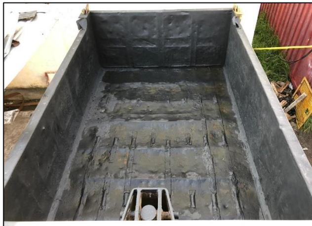
**Figura 21 Cajón con recubrimiento de bate piedra.**
