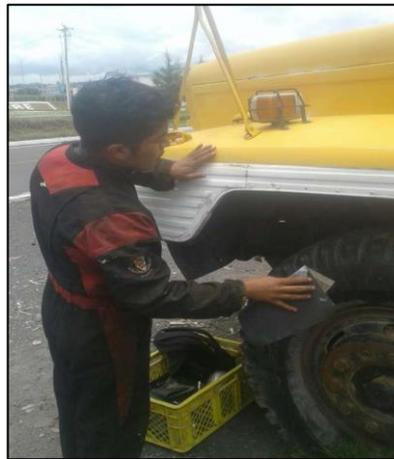
**Figura 15 Lijado de la cabina.**
