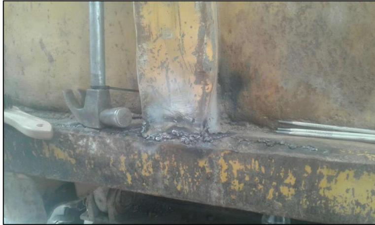
**Figura 22 Reforzamiento externo del cajón.**
