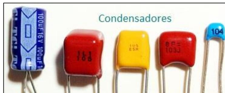
**Figura 4 Tipos de condensadores.**
