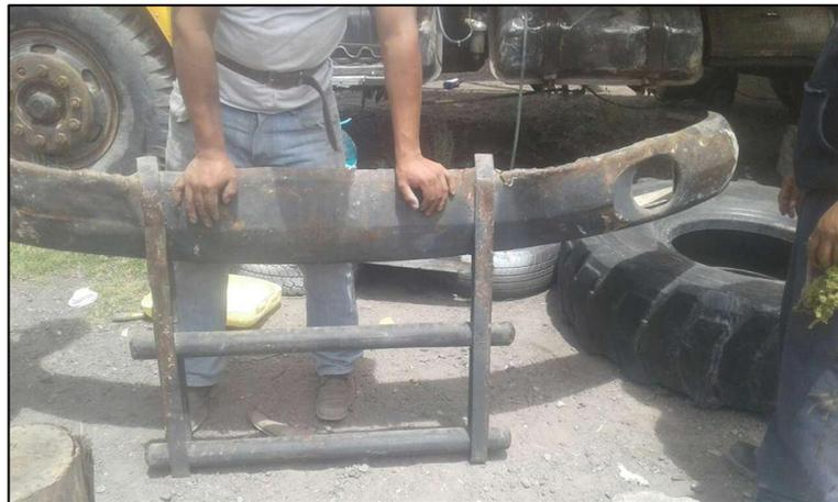
**Figura 27 Guardachoque desmontado.**
