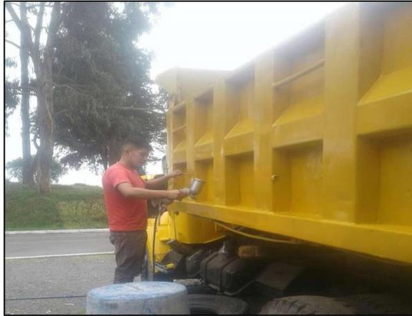
**Figura 23 Pintado externo del cajón.**
