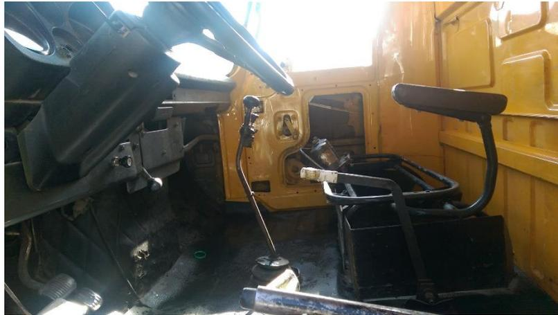
**Figura 13 Cabina lista para su reparación.**
