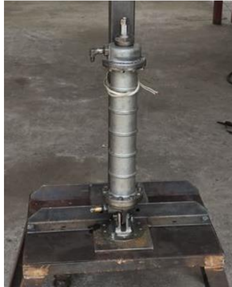
Figura 33. Montaje cilindro hidráulico
