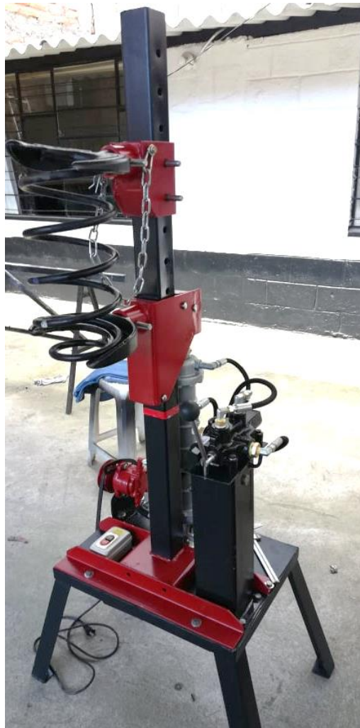
Figura 38. Prensa para muelles de suspensión
