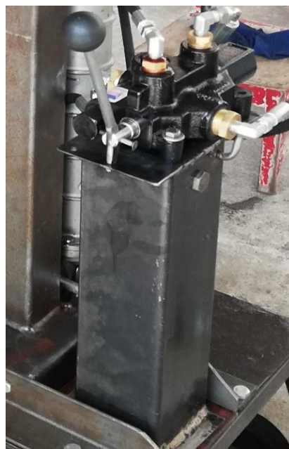
Figura 29. Ensamblaje del depósito
