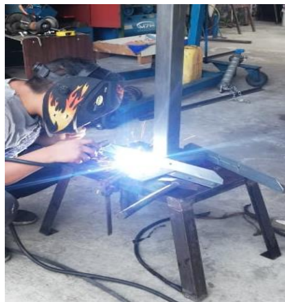
Figura 25. Base y Columna
