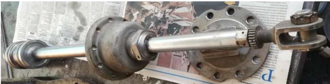
Figura 31. Desmontaje del cilindro
