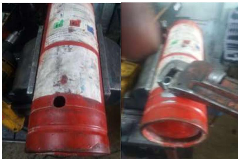
**Figura 24.** Perforación del cilindro e incrustación de acople
