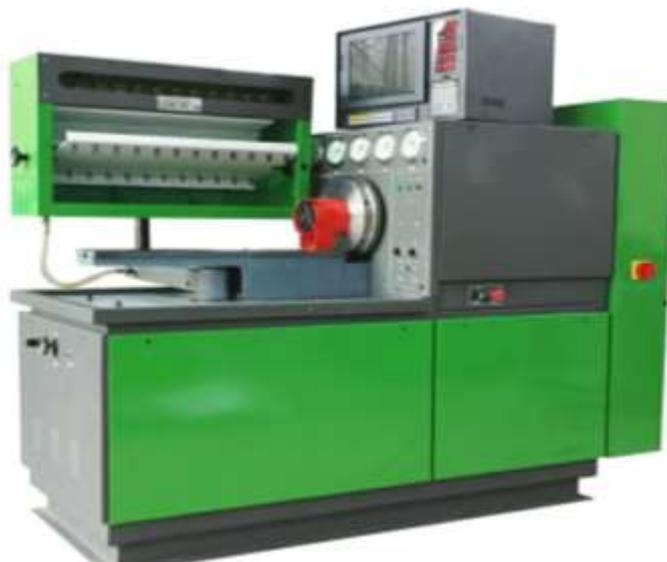
**Figura 11.** Banco de pruebas para bombas diésel
