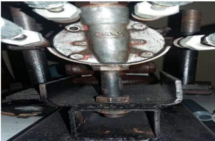
**Figura 30.** Soporte de bombas de inyección rotativas
