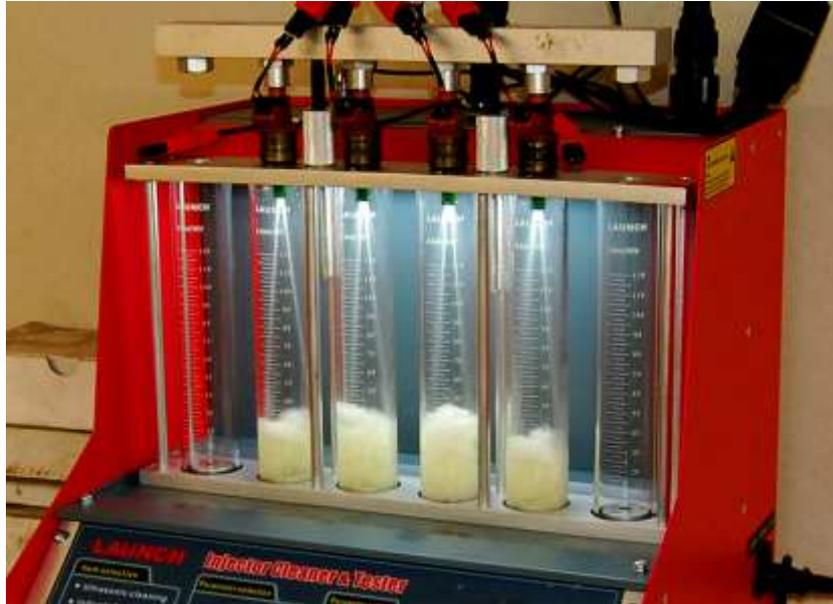
**Figura 1.** Banco de pruebas de inyectores
