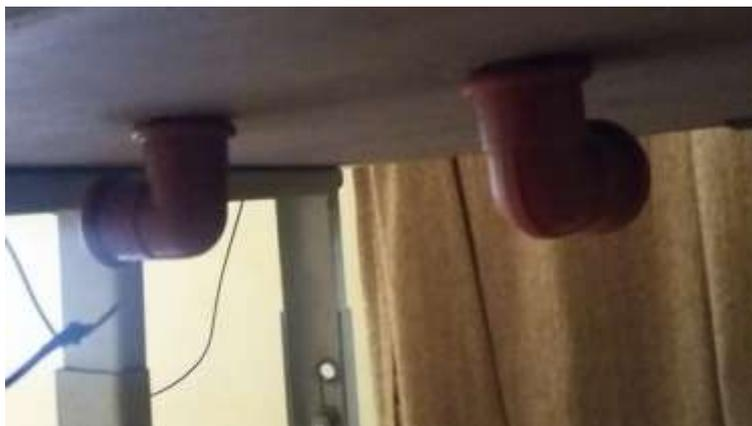
**Figura 35.** Acoples de salida de diésel
