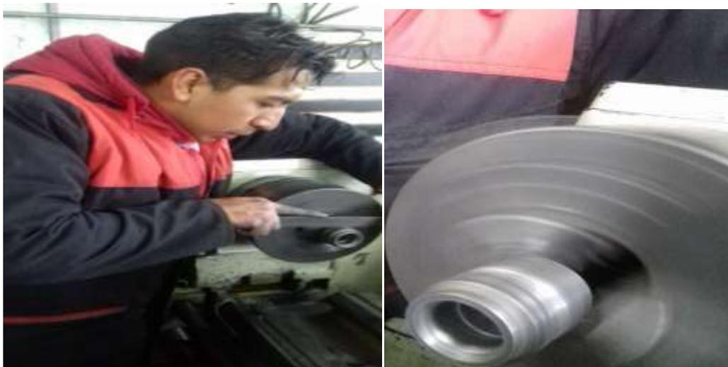
**Figura 32.** Polea para motor trifásico
