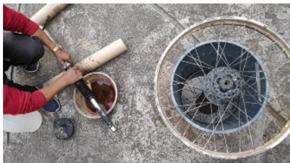
Figura 66. Limpieza de aro y barras de suspensión
