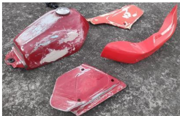
Figura 64. Aplicación de masilla
