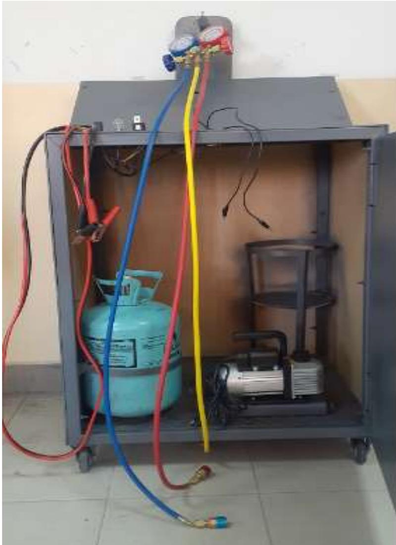
Banco de pruebas del sistema de aire acondicionado materializado para realizar pruebas de funcionamiento.
