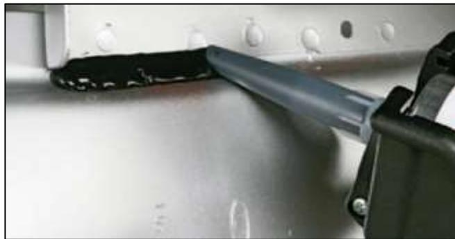
*Nota:* La figura nos indica la aplicación de un adhesivo en la carrocería. Tomado de (autocrash, 2017).
