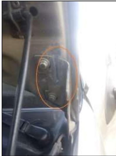
*Nota:* La figura nos indica la bisagra de desensamble del capot.
